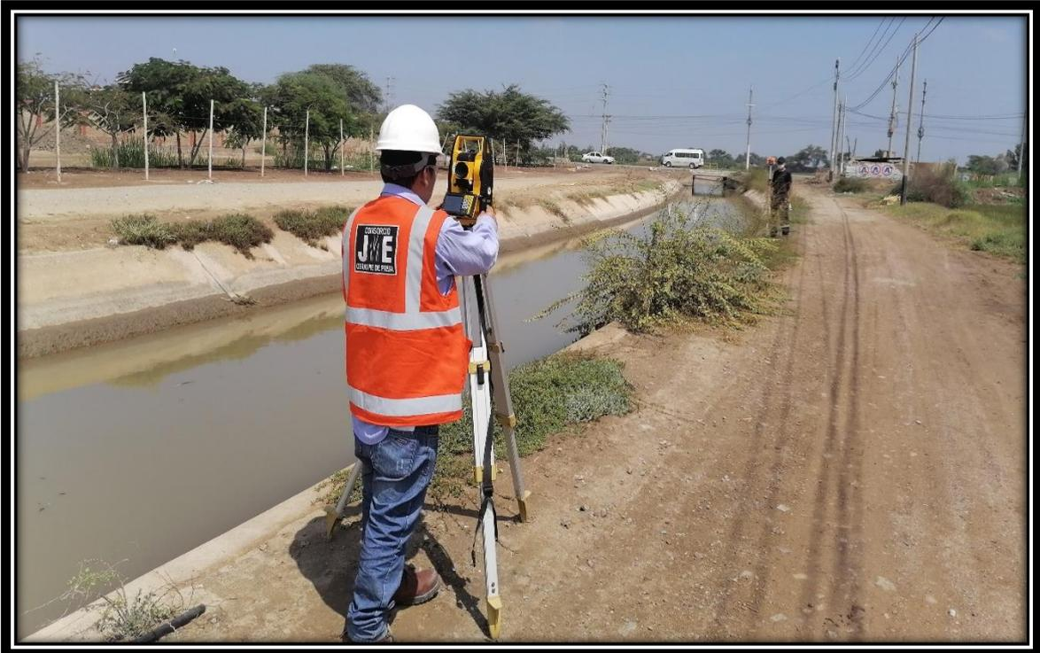
Figura 3: Lectura de los niveles del primer punto del levantamiento topográfico.
