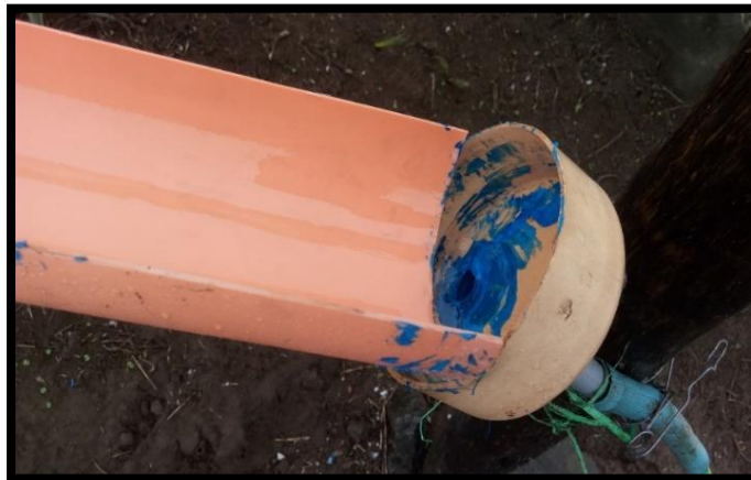
Figura 19, canales ubicados en la parte inferior del panel.
