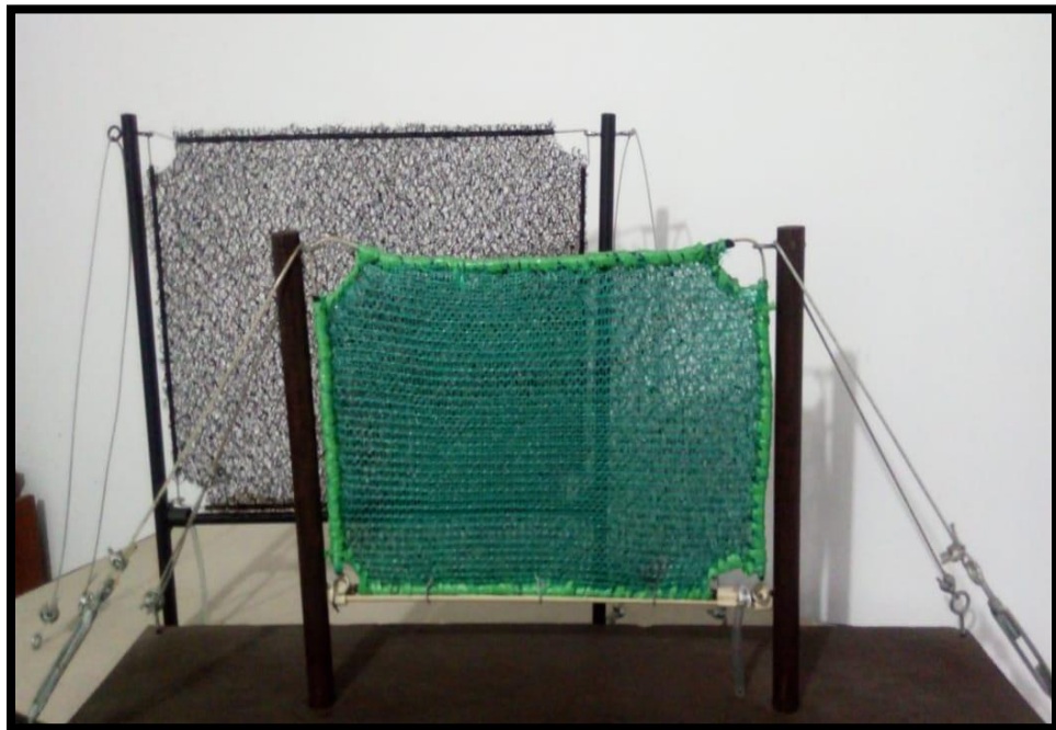
Figura 6 , maqueta del panel Raschel con malla 80% de sombra.
