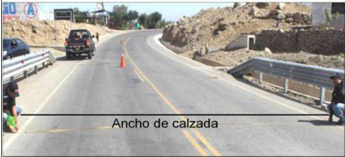
Figura II.46 Medición del ancho de calzada
