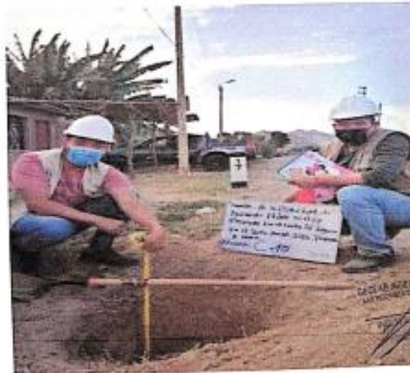
FOTOS ESCAVACION DE CALICATA C-10
