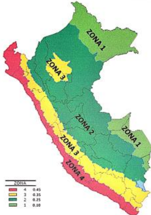
FIGURA N° 1: Mapa de Zonificación Sísmica del Perú, según el Reglamento Nacional de Edificaciones (2018)
