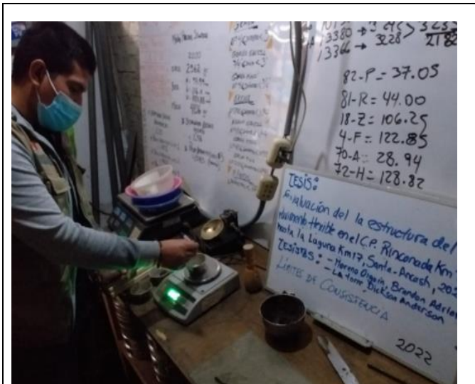
Fotografía: pesado de muestras para hacer ensayo de límites de Atterberg
