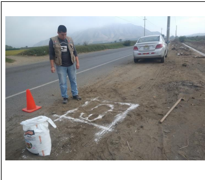
Fotografía: ejecución de calicata 3 para extracción de muestras
