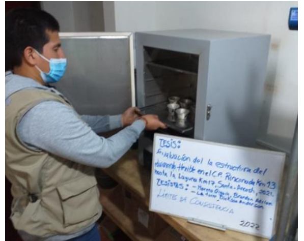
Fotografía: muestras llevadas al horno luego de haber realizado en el instrumento cuchara de Casagrande
