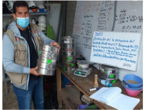
Fotografía: granulometría por tamizado para determinar el tamaño de los materiales que componen a las muestras extraídas
