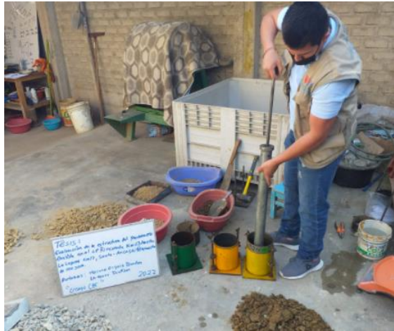
Fotografía: ejecución de compactación de 56, 25 y 12 golpes por 5 capacitación para ensayo de CBR.
