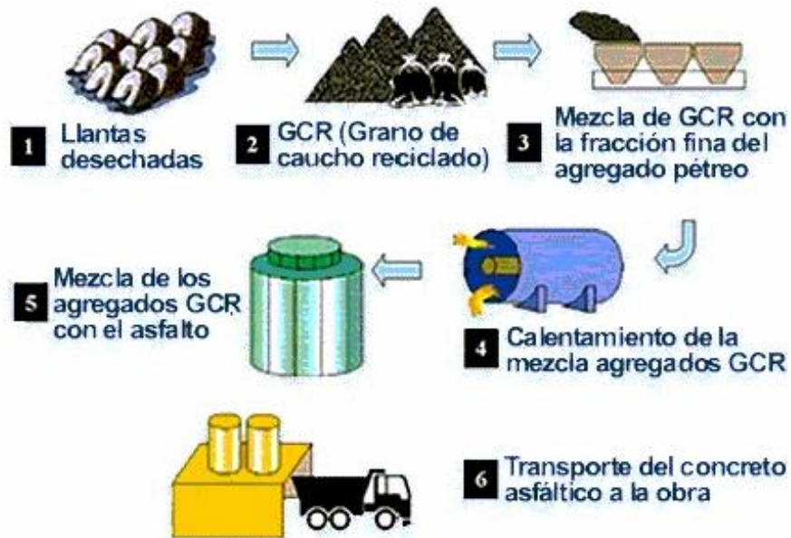
Figura 5. Proceso de adición del Granulo de Caucho Reciclado (GCR) por vía seca. Tomado de "Uso de polvo de caucho de llantas en pavimentos asfálticos", por Rodríguez, 2016, p. 5.
