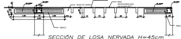
SECCIÓN TIPO EN DOS SENTIDOS - AJUSTAR DIMENSION DE CASETÓN EN EXTREMOS ESC. 1/25
