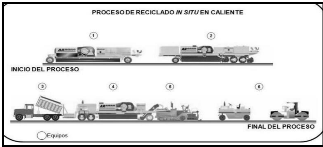
Fig. 2: Proceso De Reciclaje De Pavimento. Fuente: Martec Recycling, 2010.
