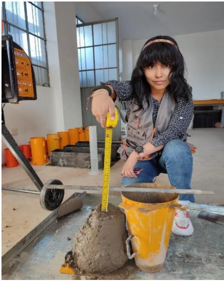
Figura 35. Revisión del Revenimiento Slump patrón.
