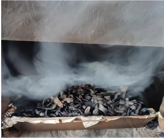
Figura 7. Calcinación de la cáscara de Papa
