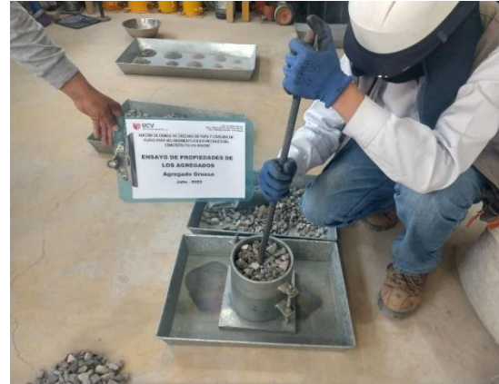
Figura 23. Compactación de Agregado Grueso
