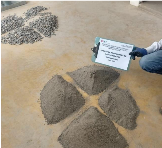
Figura 17. Cuarteo Agregado Fino.
