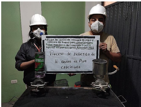
Figura 9. Proceso molido de la ceniza de cáscara de papa con máquinas manuales.
