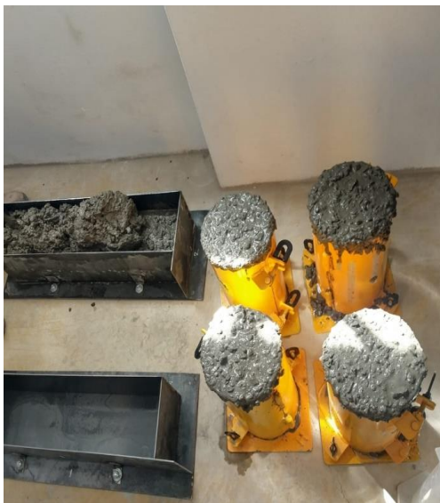
Figura 28. Vaciado de Probetas cilíndricas.
