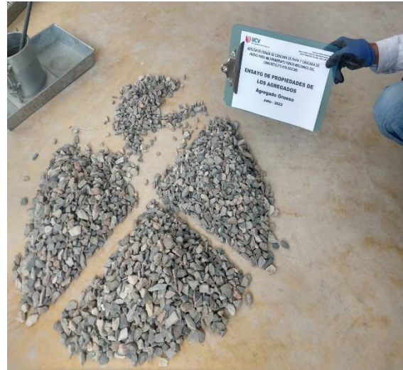
Figura 18. Cuarteo Agregado Grueso.
