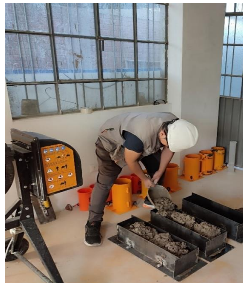
Figura 29. Vaciado de Probetas prismáticas.
