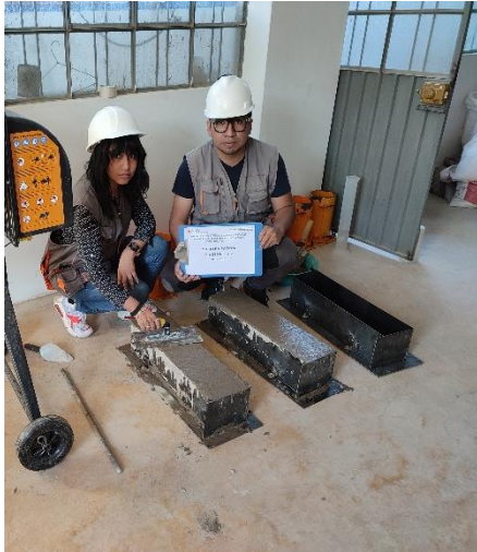
Fotografía 7: Aplicación de plancha metálica para la superficie lisa y plana
