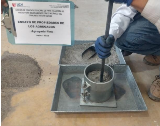
Figura 22. Compactación de Agregado Fino
