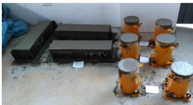
Figura 30. Probetas a Carga Axial y Flexión armadas.
