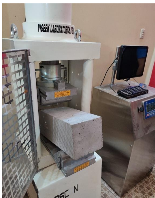
Figura 46. Ensayo de flexión en viga. Fuente: Propia.
