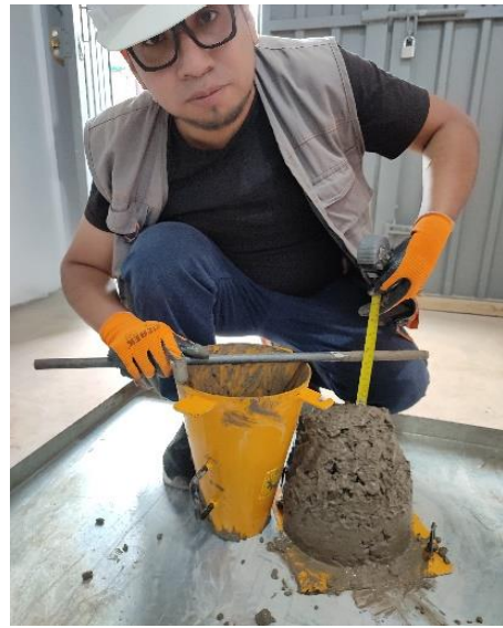
Figura 36. Ensayo de Slump con adición de variables.
