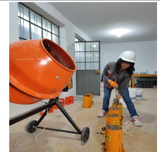
Fotografía 5: Chuzeadas con varilla lisa en muestras cilíndricas
