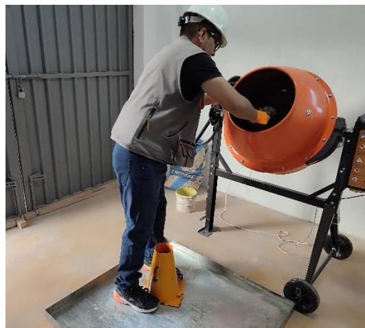
Fotografía 4: Preparado de ensayo de Slump
