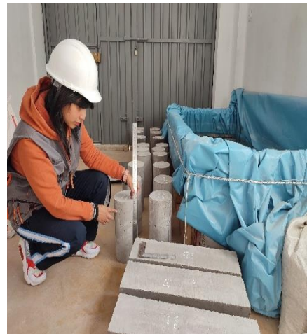
Fotografía 10: Mediciones de nuestras probetas cilíndricas y prismáticas
