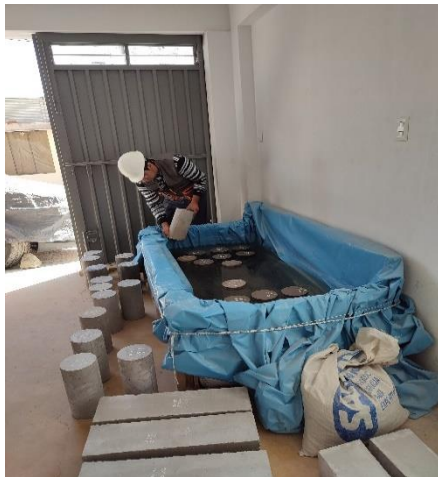
Fotografía 9: Finalización de curado de las muestras sobrantes a los 28 días.
