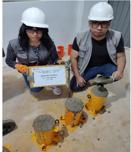
Fotografía 8: Vaciado en moldes cilíndricos de la muestra patrón
