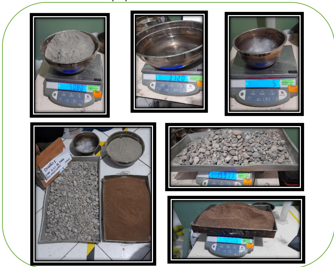
Figura 10: Diseño 1- M. Patrón + 0.005 kg de F. Polipropileno
