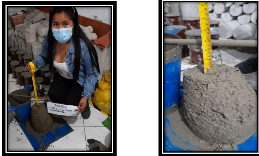
Figura 14: Mezcla Patrón + 0.1% de Fibra de Polipropileno
