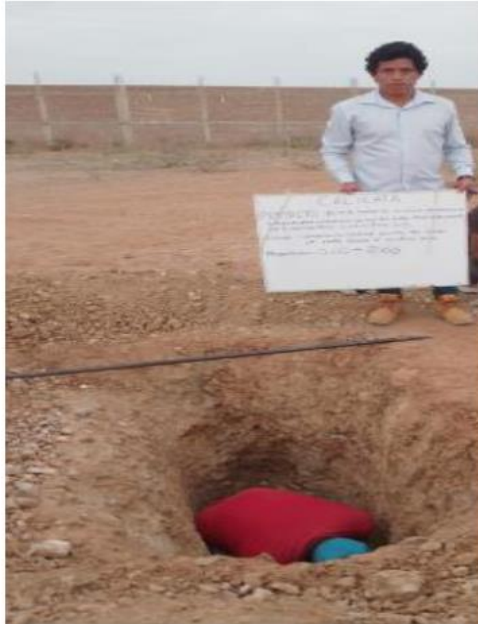
FOTO N°03: Vista donde se observa al personal técnico alcanzando la profundidad de 2.00 metros en la Calicata (C-1).
