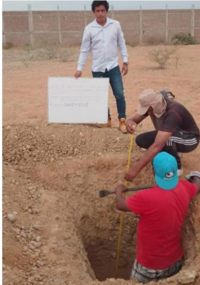
FOTO N°02: Vista donde se observa al personal técnico alcanzando la profundidad de 1.25 metros en la Calicata (C-1).
