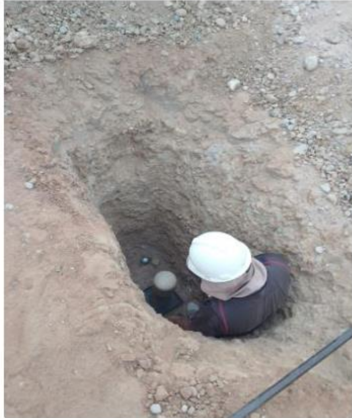
FOTO N°04: Vista donde se observa al personal técnico aplicando el método del cono de arena para calcular la densidad natural del suelo, calicata (C-1)
