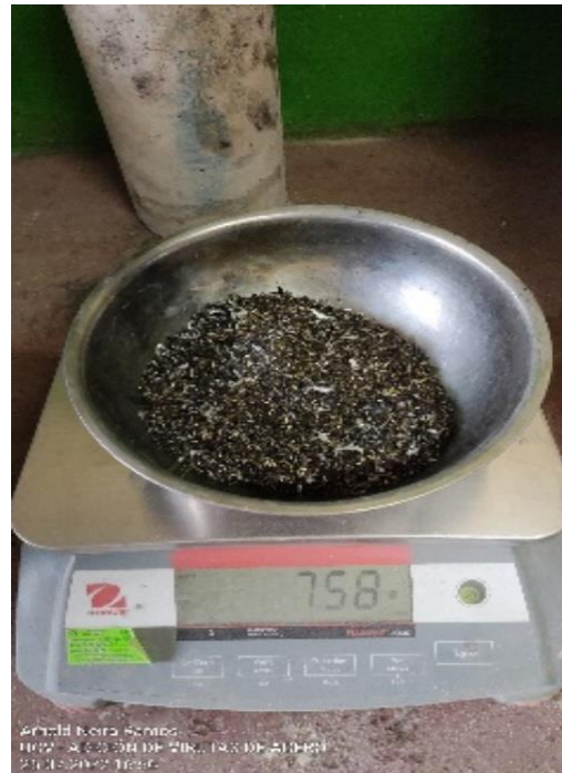
Foto 6: Pesado de viruta de acero para preparación de concreto.
