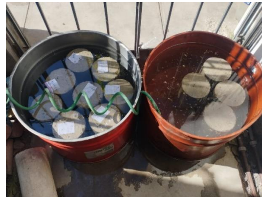
Foto 20: Curado de probetas cilíndricas de concreto.
