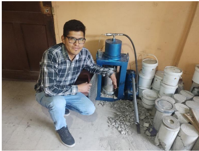
Figura 22. Ensayo de resistencia a la compresión en probetas cilíndricas.
