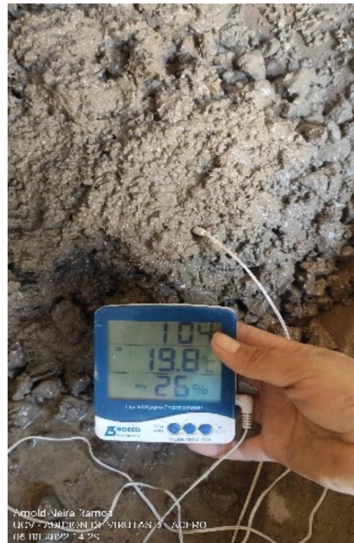
Foto 12: Toma de temperatura del concreto fresco.
