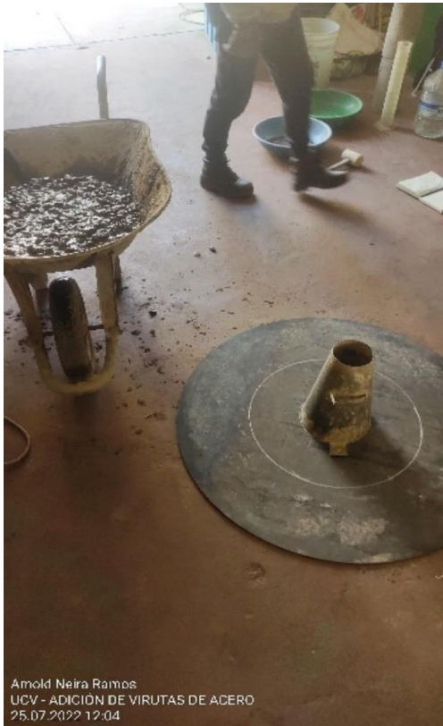
Foto 13: Ensayo de asentamiento del concreto.
