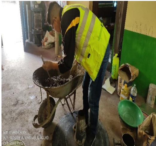
Foto 15: Ensayo de asentamiento del concreto.
