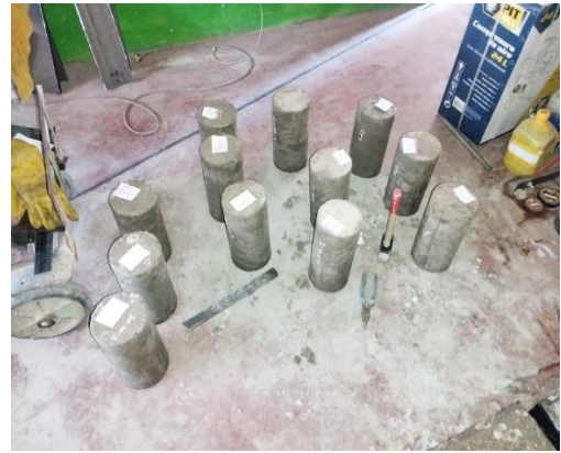
Figura 35. Desencofrado para medición de probetas.
