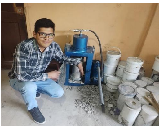
Figura 37. Rotura de probetas cilíndricas.
