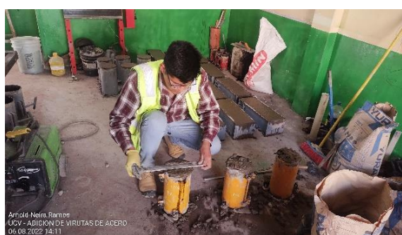
Figura 17. Enrazado de probetas de concreto
