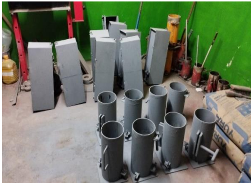
Foto 5: Preparación de moldes para vaciado de probetas cilíndricas y vigas.
