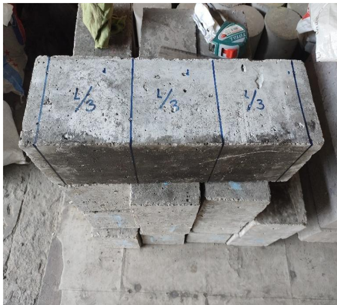
Figura 40. Demarcación de tercios de viga de concreto.
