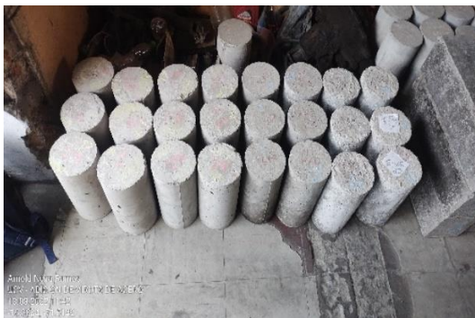
Foto 21: Probetas cilíndricas de concreto.
