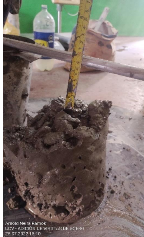
Foto 14: Ensayo de asentamiento del concreto.
