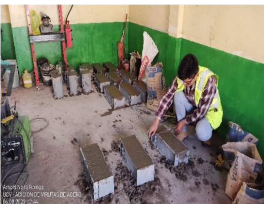
Foto 31: Enrazado de concreto en moldes de vigas.
