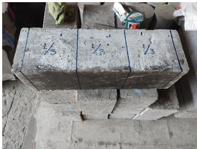
Figura 24. Vigas para realizar el ensayo resistencia a la flexión.
