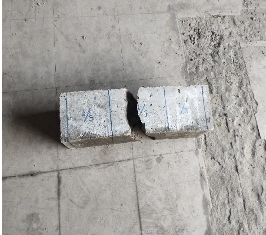
Foto 39: Viga sometida a ensayo de resistencia a la flexion.
