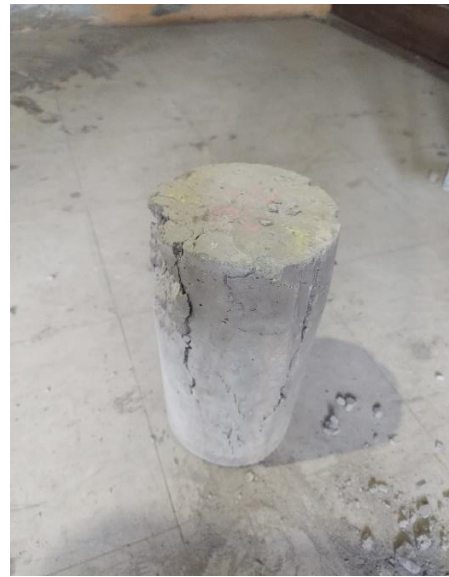
Figura 23. Probeta cilíndrica sometida al ensayo de resistencia a la compresión.
