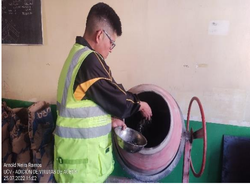
Foto 9: Incorporación de virutas de acero a concreto.
