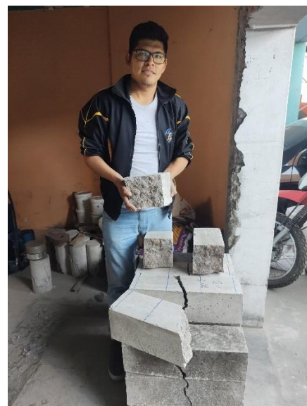
Figura 25. Vigas sometidas al ensayo resistencia a la flexión.
