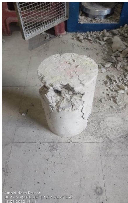
Foto 24: Probetas cilíndricas sometidas a ensayos de resistencia a la compresión.
