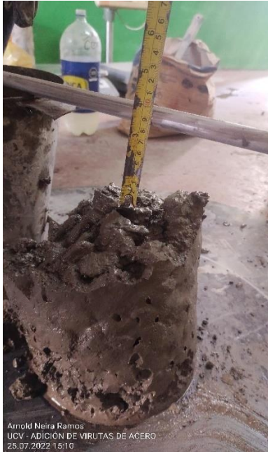
Figura 31. SLUMP del concreto fresco.
