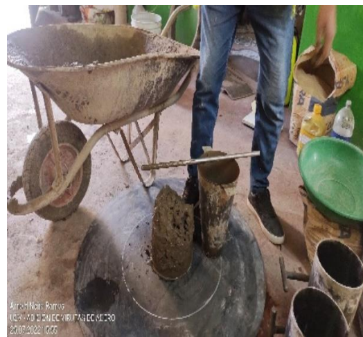
Foto 16: Ensayo de asentamiento del concreto.
