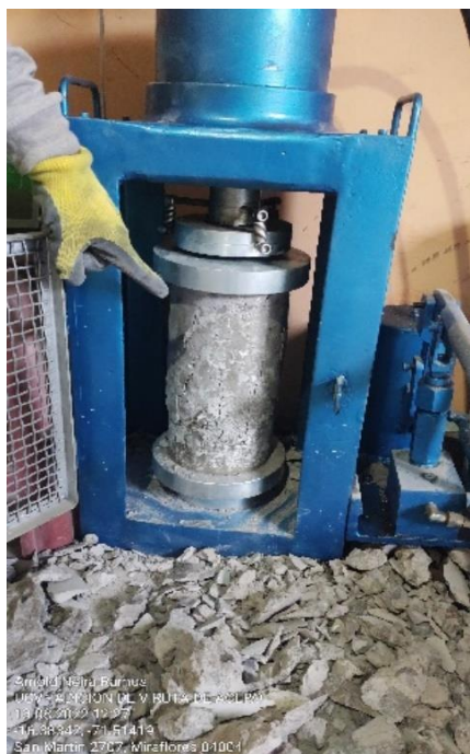
Foto 23: Probetas cilíndricas sometidas a ensayos de resistencia a la compresión.
