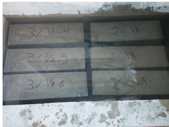
Figura 19. Curado de vigas de concreto
