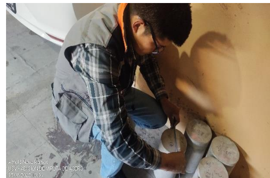
Foto 22: Toma de medidas de probetas cilíndricas de concreto.
