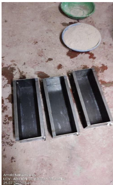
Foto 25: Preparación de moldes para vaciado de concreto en vigas.
