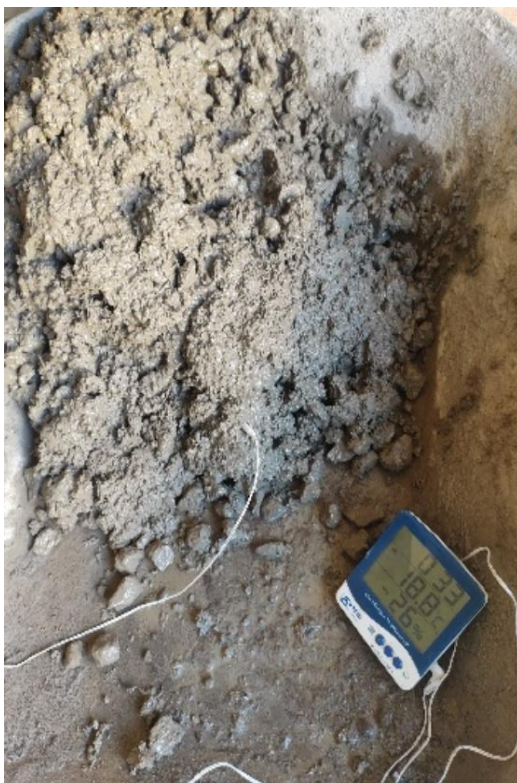
Foto 11: Toma de temperatura del concreto fresco.
