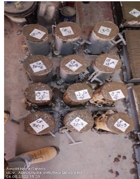
Foto 18: Demarcación de probetas cilíndricas de concreto.
