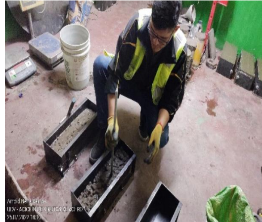
Foto 28: Varillado de capas de concreto en vigas.
