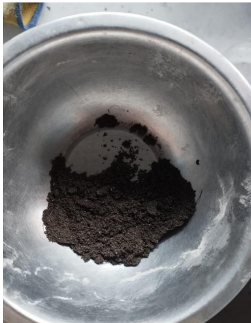
Foto 3: Material fino obtenido de la viruta de acero reciclada.
