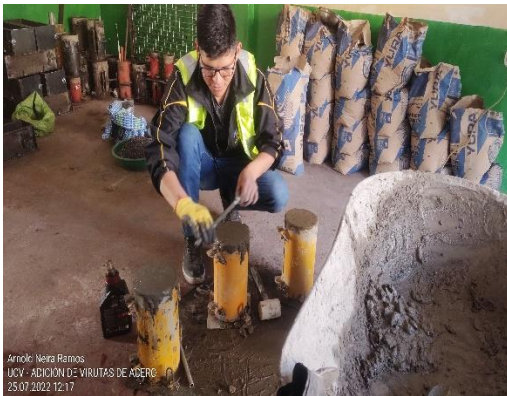
Foto 17: Enrazado de probetas cilíndricas de concreto.
