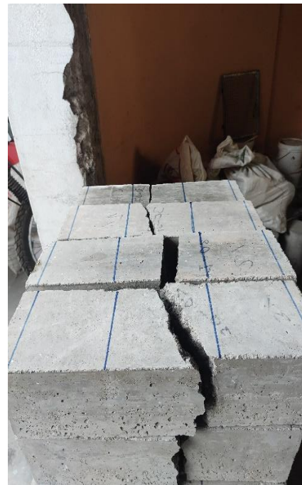
Figura 41. Vigas sometidas a resistencia a la flexión.
