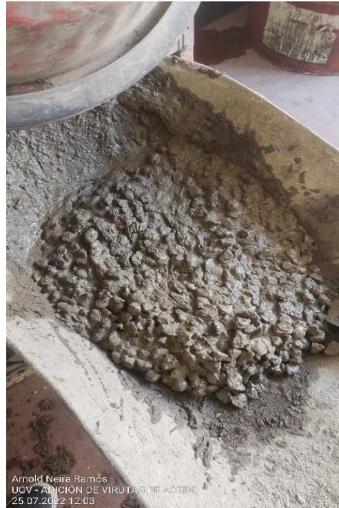
Foto 10: Concreto con viruta de acero.
