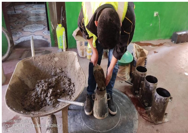
Figura 20. Ensayo Slump al concreto patrón.
