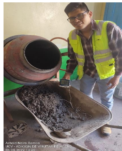
Figura 21. Toma de temperatura de concreto fresco
