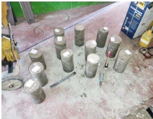
Foto 19: Desencofrado de probetas cilíndricas de concreto.
