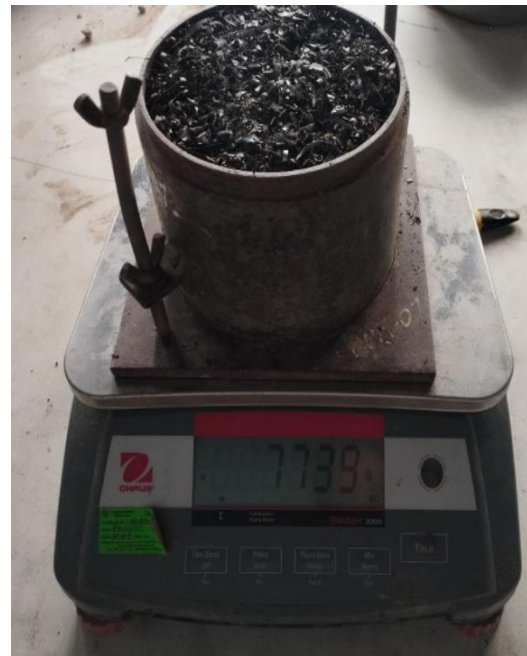
Foto 4: Ensayo de peso unitario de la viruta reciclada de acero.
