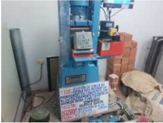
Figura 21. Prueba de resistencia a flexión
