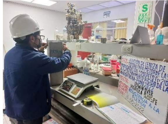
Foto N° 14. Medición y pesado de probetas prismáticas.
