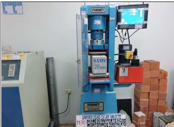
Foto N° 29. Ensayo de resistencia a la flexión de probeta prismática.
