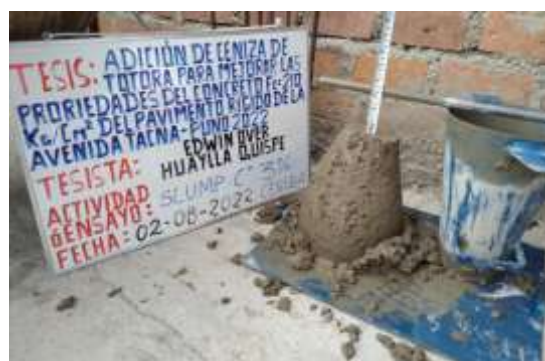
Figura 16. Medición del asentamiento
