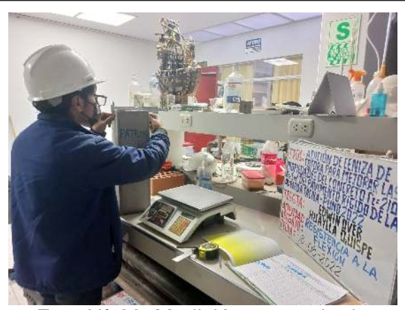
Foto N° 26. Medición y pesado de probetas prismáticas.
