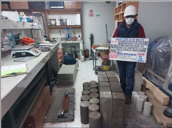
Foto N° 25. Rotura de probetas de concreto a los 28 días de curado.
