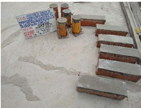
Foto N° 15. Medición y pesado de probetas prismáticas.
