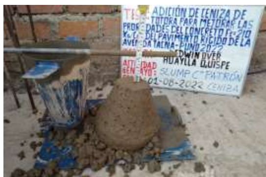
Figura 15. Prueba de slump
