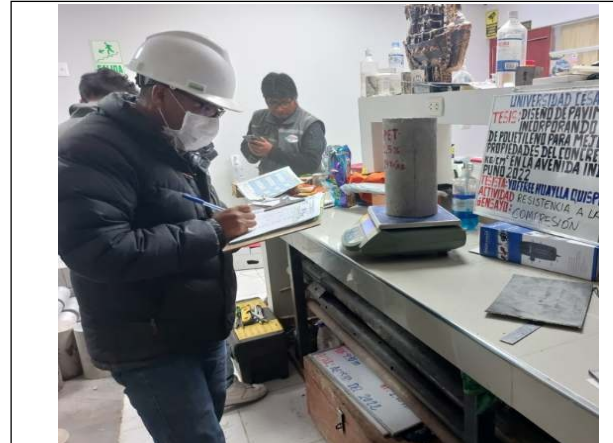
Foto N° 20. Medición y pesado de probetas cilíndricas.
