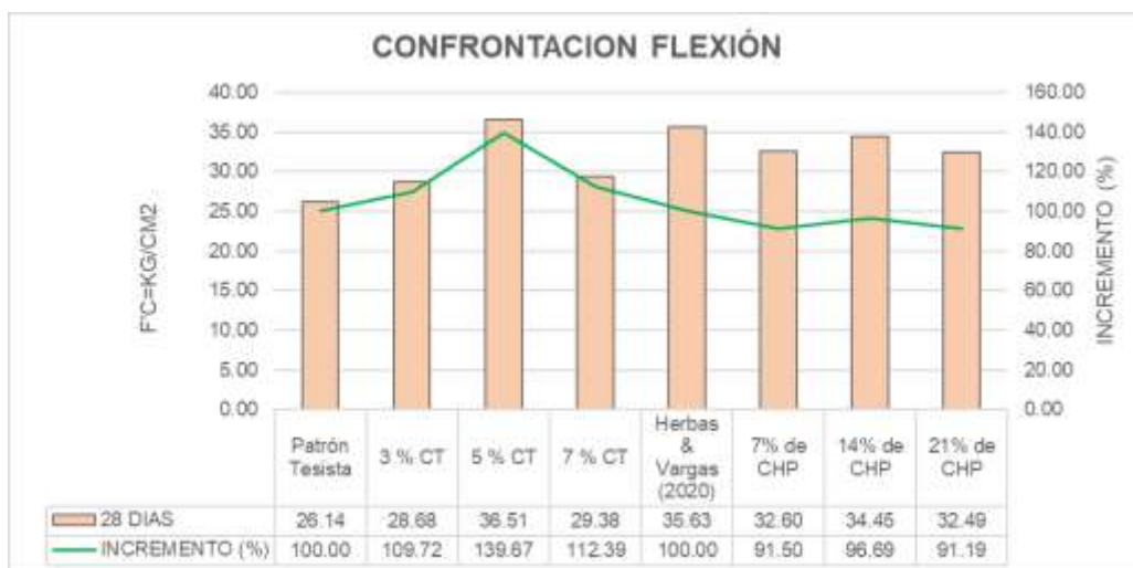
Figura 29. Confrontación de la resistencia a la flexión.
