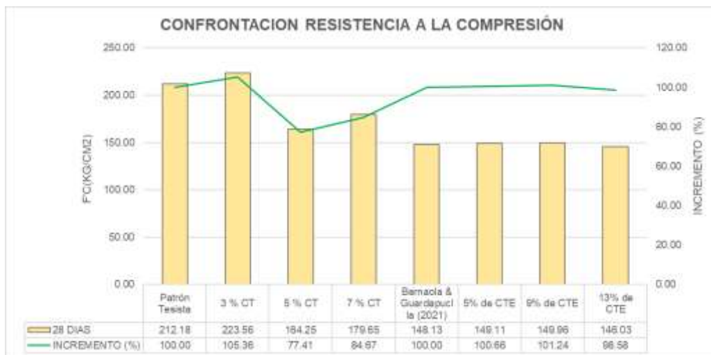
Figura 26. Confrontación de la resistencia a la compresión.
