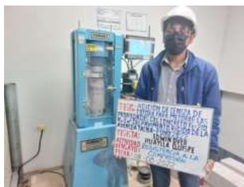
Figura 19. Prueba de resistencia a compresión
