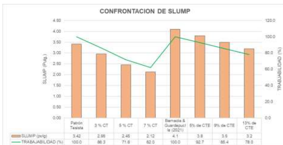
Figura 24. Contrastación del SLUMP con la trabajabilidad.
