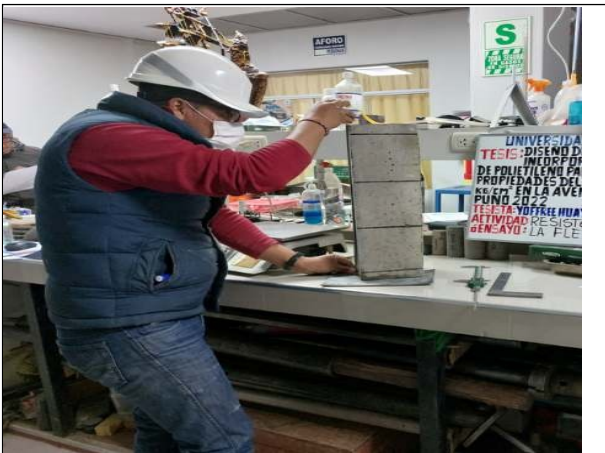
Foto N° 27. Medición y pesado de probetas prismáticas.
