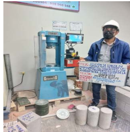
Foto N° 16. Ensayo de resistencia a la compresión de probeta cilíndrica.
