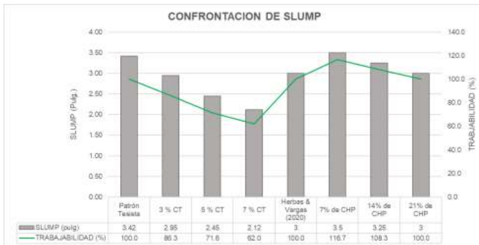
Figura 25. Contrastación del SLUMP con la trabajabilidad.
