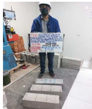
Foto N° 18. Probetas prismáticas ensayadas.
