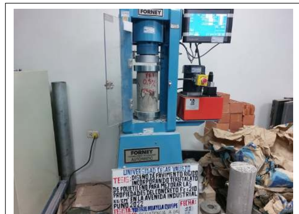
Foto N° 22. Ensayo de resistencia a la compresión de probeta cilíndrica.
