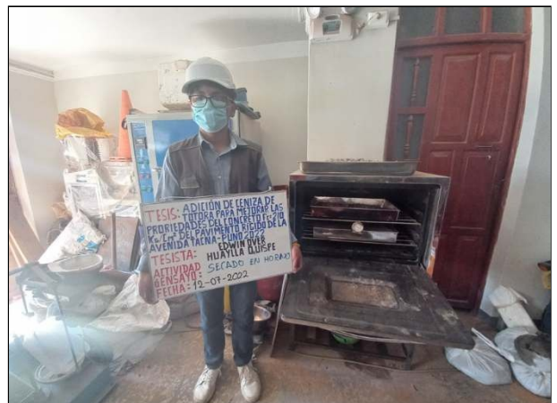
Foto N° 6. Ensayo de contenido de humedad.
