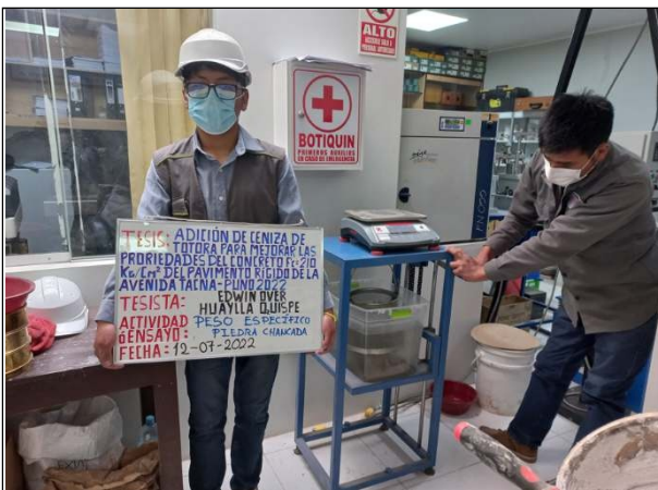
Foto N° 5. Ensayo de peso específico de grava.
