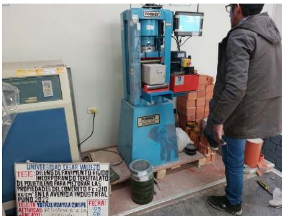
Foto N° 17. Ensayo de resistencia a la flexión de probeta prismática.
