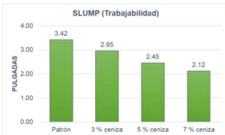
Figura 17. Resultados de la prueba de trabajabilidad del concreto
