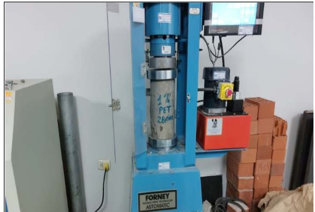
Foto N° 28. Ensayo de resistencia a la compresión de probeta cilíndrica.
