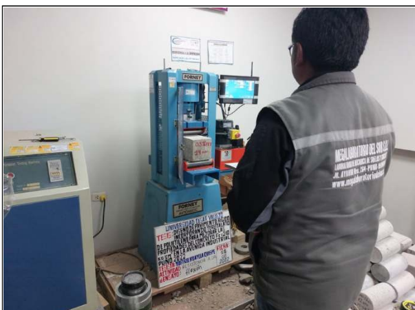
Foto N° 23. Ensayo de resistencia a la flexión de probeta prismática.
