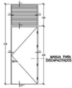
PUERTA CON MANIJA PARA DISCAPACITADOS ESC. 1:20
