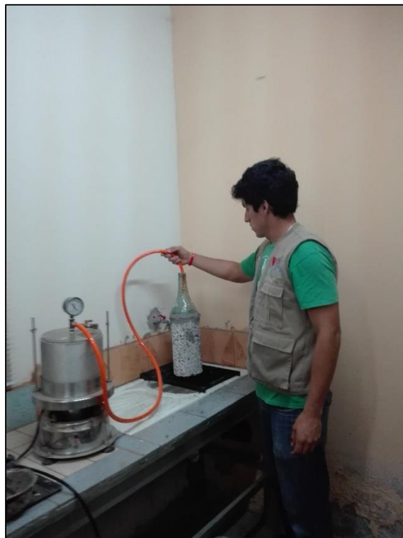
IMAGEN 04: Realización del ensayo para determinar la tasa de infiltración.
