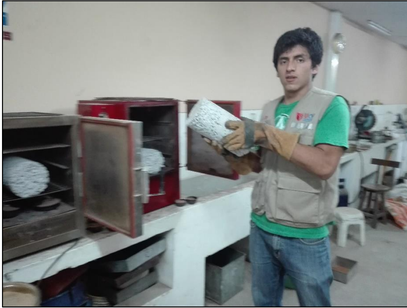
IMAGEN 03: Retirando las probetas del horno para ser pesadas y determinar el porcentaje de vacíos interconectados.
