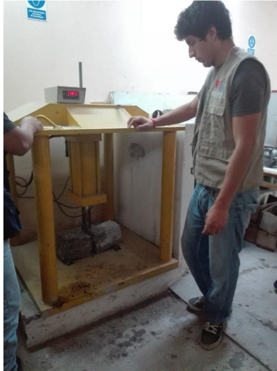
IMAGEN 05: Realización del ensayo de resistencia a la flexión a viga a los 28 días
