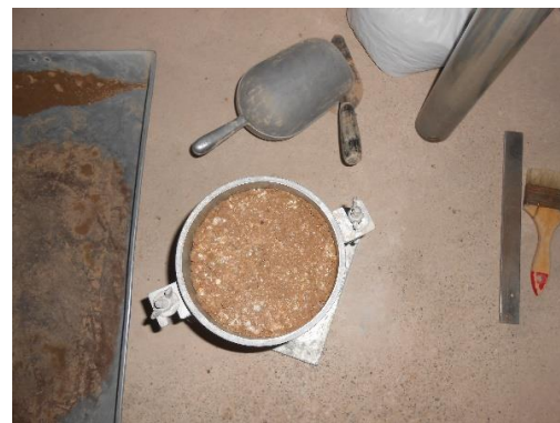
Fotografía 28: Gravedad específica de los suelos.
