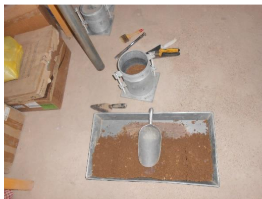
Figura 20. Mezcla de muestra + polvo de piedra triturada + humedad óptima.
