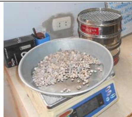
Fotografía 18: Pesaje de grava en balanza digital.
