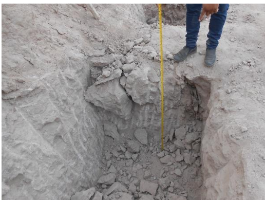
Fotografía 11: Profundidad de calicata C3
