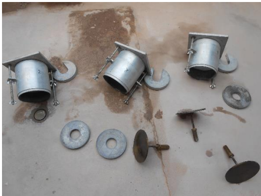
Fotografía 33: Drenado de muestras CBR.
