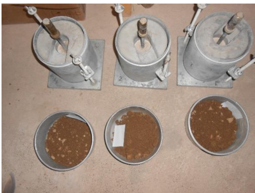
Fotografía 29: Muestras compactadas para CBR.
