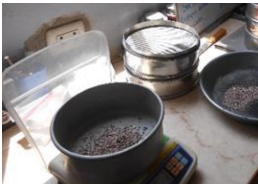
Fotografía 15: Cuarteo de muestras para ensayos
