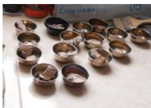
Figura 17. Taras con muestras dosificadas al 5%, 10% y 20% de polvo de piedra triturada.
