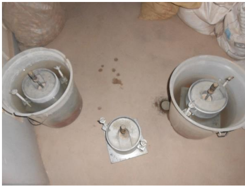
Fotografía 31: Saturación de muestras en agua.
