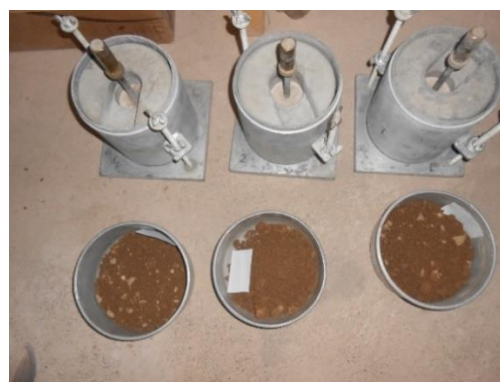
Figura 24. Muestra CBR con La incorporación del 5%, 10% y 20% de Polvo de Piedra Triturada.
