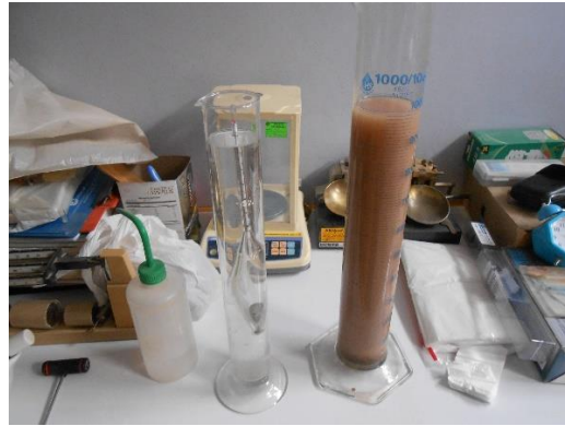
Fotografía 26: Granulometría por sedimentación.
