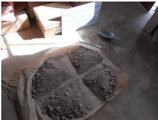
Fotografía 15: Cuarteo de muestras para ensayos
