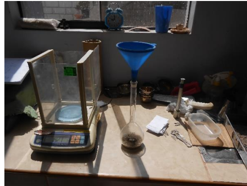
Fotografía 28: Gravedad específica de los suelos.
