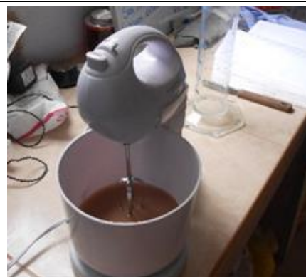
Fotografía 24: Ensayo de sedimentación de suelos finos.
