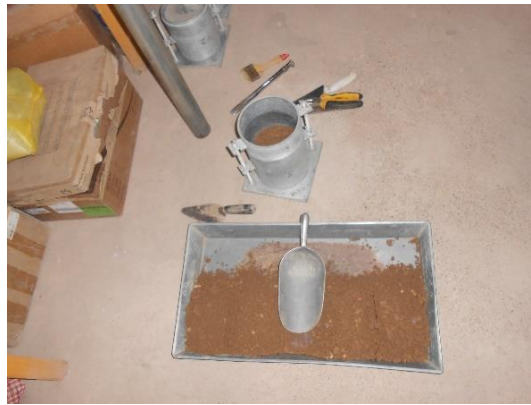
Fotografía 32: Compactado de muestras para CBR.
