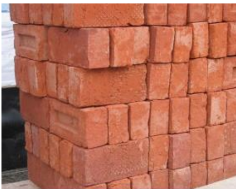
Figura 18. Ladrillos artesanales sin control técnico
