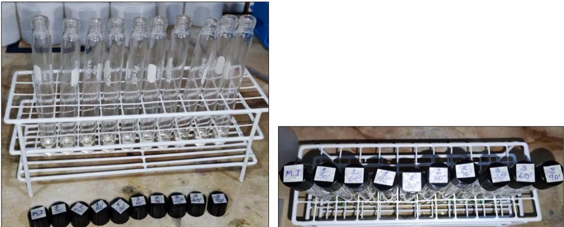
*Figura 24.* Acondicionamiento de cantidades de muestra en tubos de ensayo sellados.
