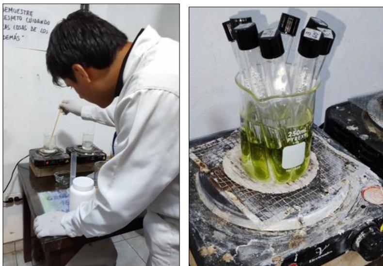
*Figura 26.* Revisión de temperatura de glicerina y calentamiento de las muestras preparadas.
