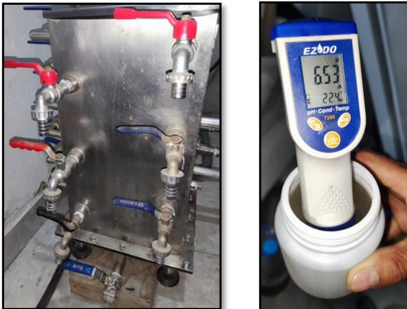
*Figura 10.* Recepción y medición de muestra tratada
