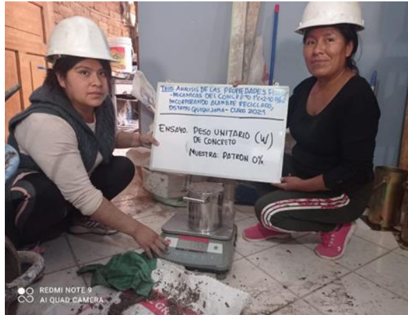
Figura 14. Ensayo de peso unitario de concreto
