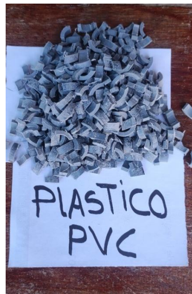
imagen 10. Formas de Triturado del Plástico PVC
