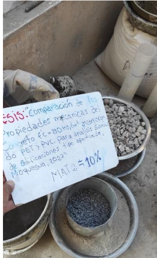
imagen 19. Materiales pétreos y PVC para mezccla de concreto
