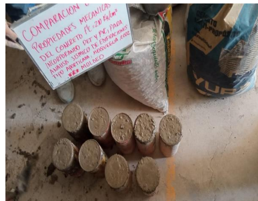
imagen 12. Probetas de Concreto con incorporación de PET
