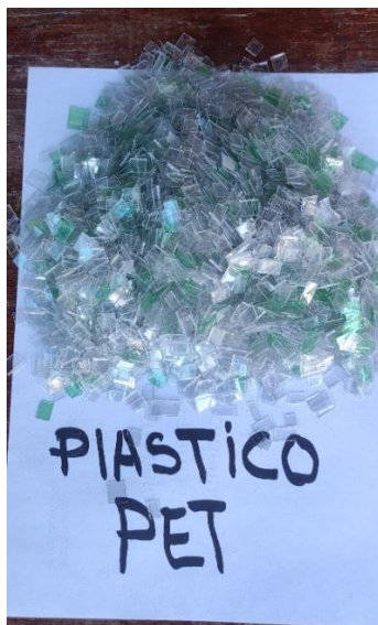
imagen 9. Formas de Triturado del plástico PET
