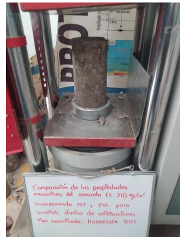
imagen 22. Ensayo a compresión concreto con PVC
