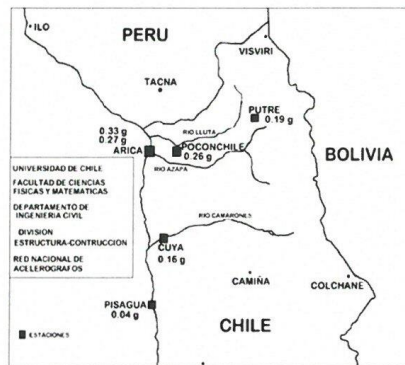
Figura N° 5.- Datos de aceleración obtenidos en Arica por la Universidad de Chile ( Boroshek). Fuente CISMID UNI (año 2001) http://www.cismid.uni.edu.pe/descargas/redacis/redacis46_p.pdf
