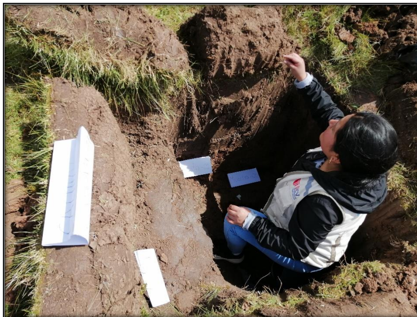
Imagen N° 3: Reconocimiento y medición de estrato.
