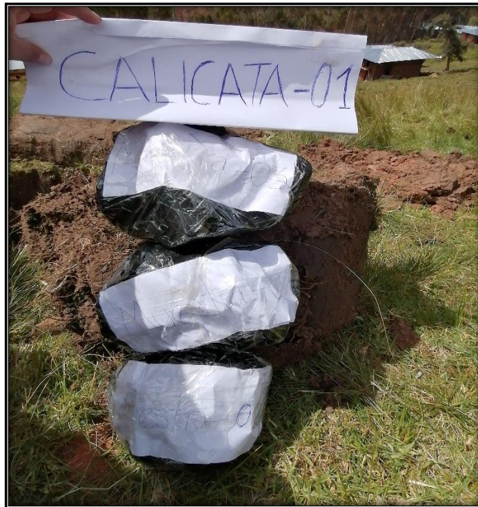
Imagen N° 2: Muestras de estrato de calicatas.
