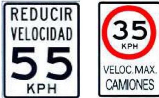
Proximidad de ingreso al puente Huaycoloro, se debe disminuir la velocidad de los vehículos motorizado especialmente de los camiones T3S3 a 35 KPH, Se sugiere colocar las señales cada 400 m antes de ingresar al puente hacia Huachipa. No Existe.
