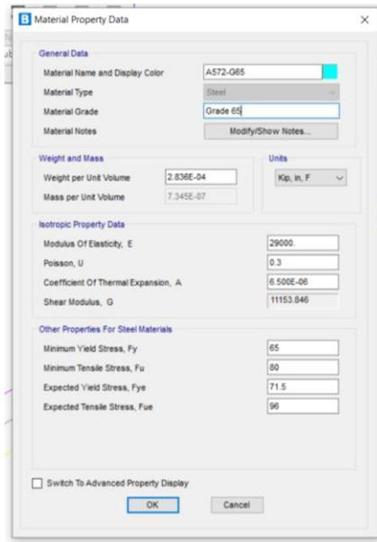
Ilustración 5 Ventana de datos de las propiedades del material del Acero ASTM A572
