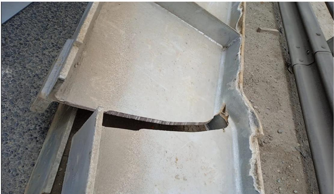
Fractura en la viga transversal, se quiebra la viga y afecta a los demás componentes
