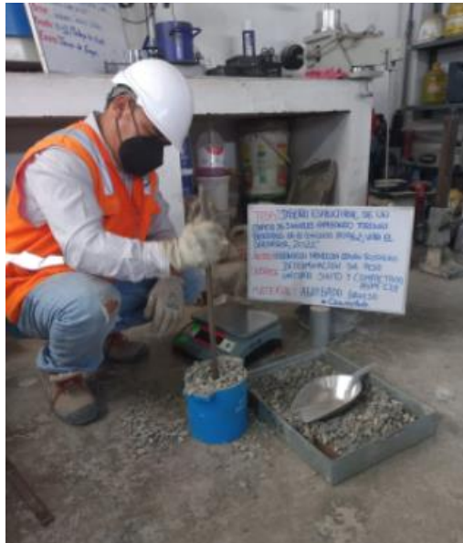
Figura 22. Peso unitario suelto y compactado del A.G
