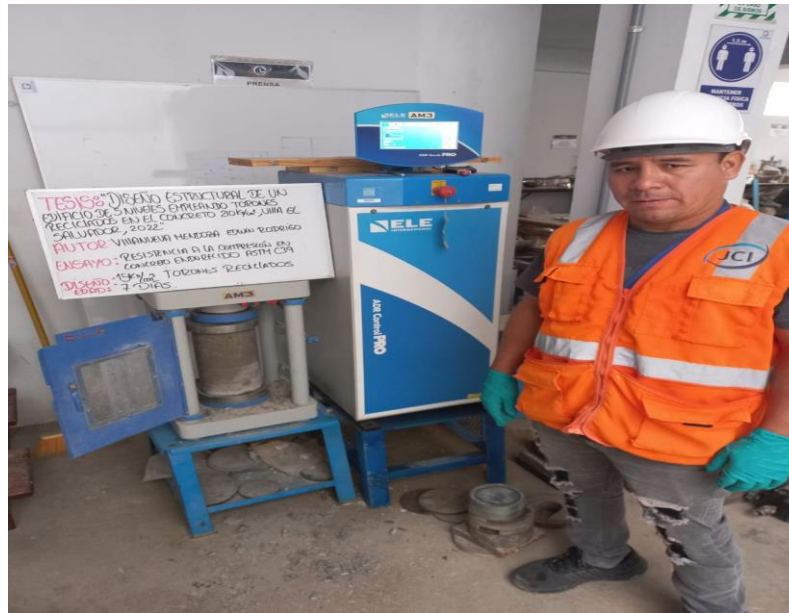
Figura 27. Ensayo de compresión 15 kg/m3 de torones reciclado
