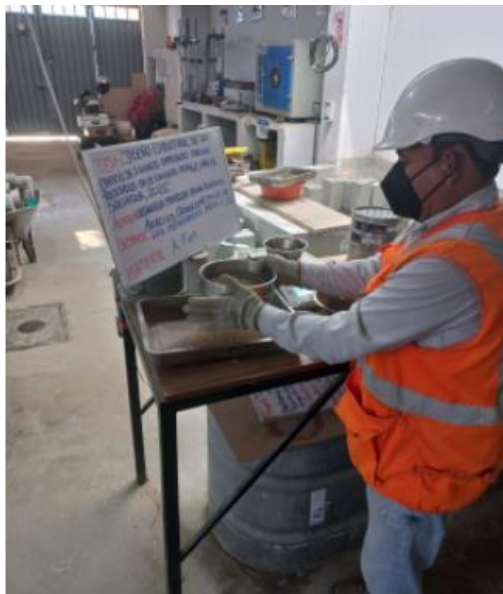
Figura 21. Análisis granulométrico del A.F
