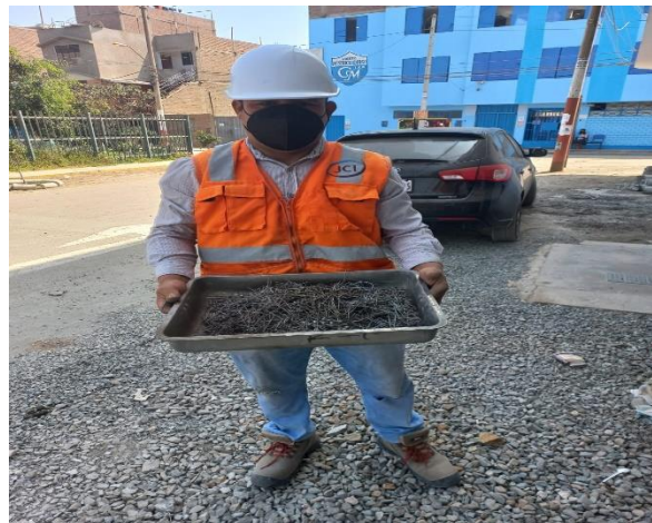
Figura 18. Longitud de 5cm los torones
