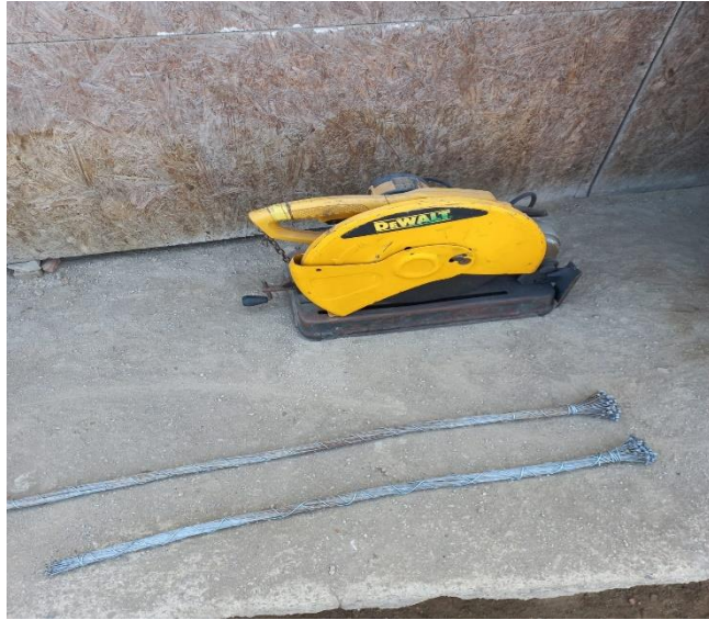
Figura 5. Torones de acero reciclado
