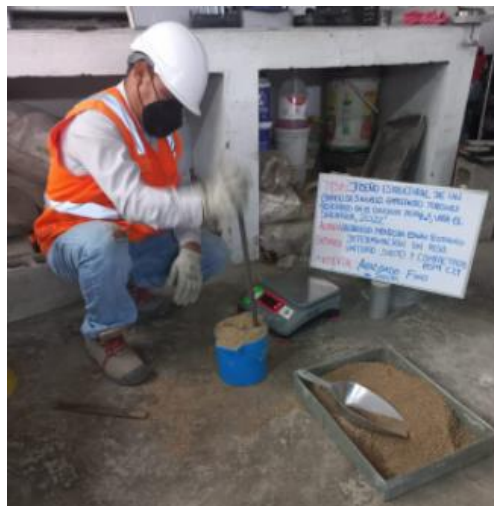
Figura 20. Peso unitario compactado del A.F
