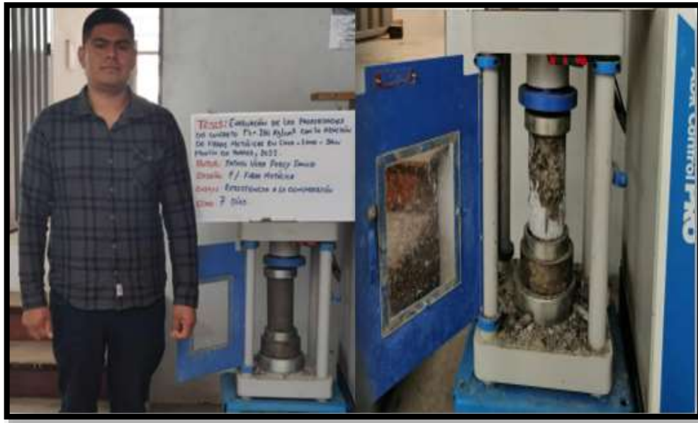
Figura 44. Ensayo de rotura de probetas
