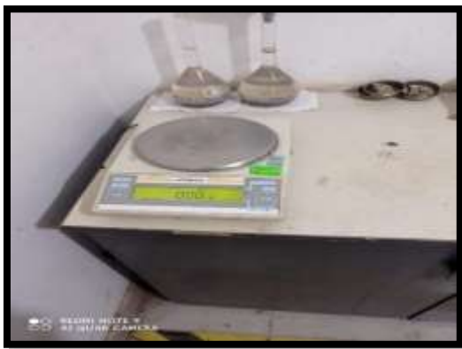
Pesado y análisis del agregado
