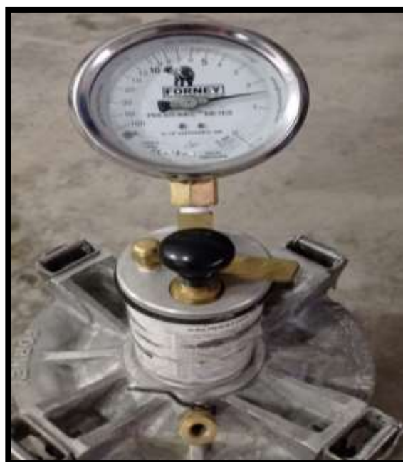
Figura 39. Medición del contenido de aire en el concreto
