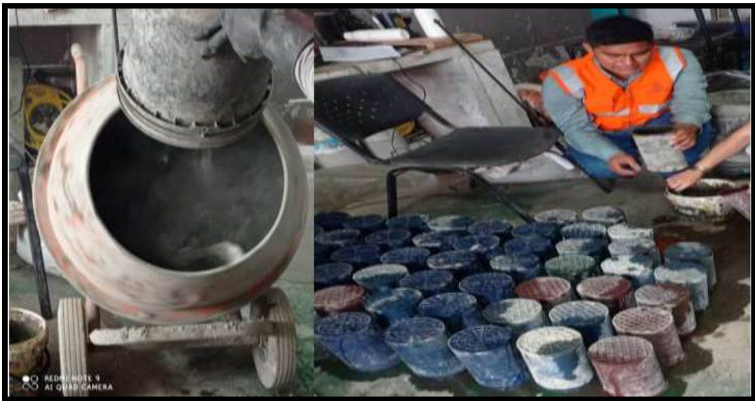
Figura 16. Preparación de las probetas cilíndricas.
