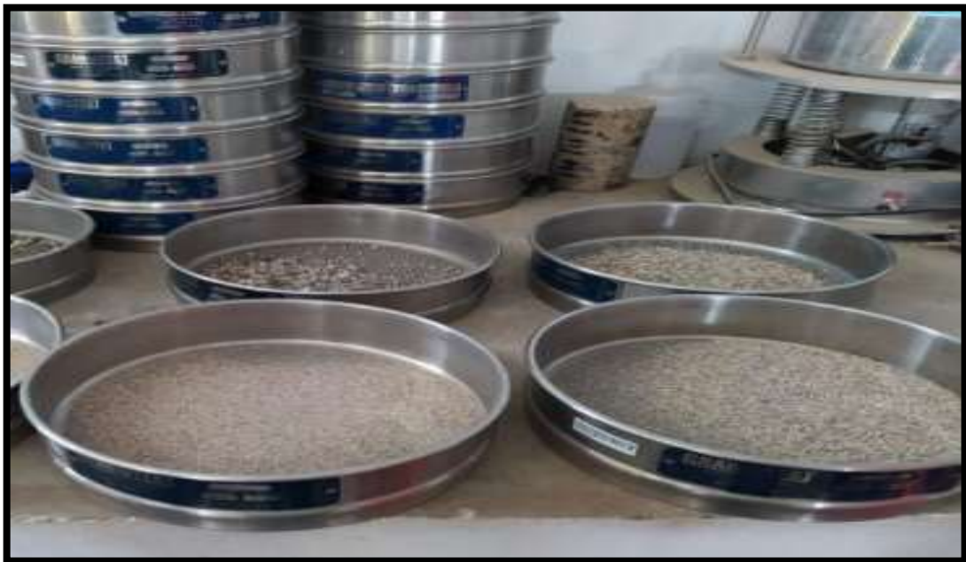
Figura 24. Agregado Fino retenido en los tamices.
