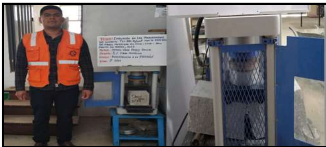
Figura 52. Ensayo de resistencia a la flexión.
