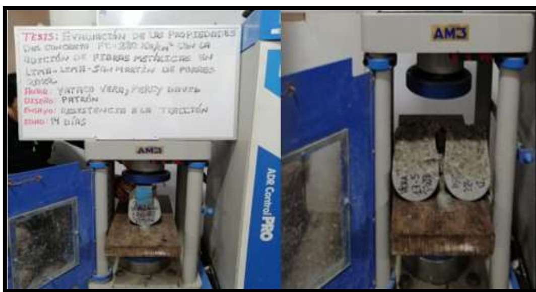
Figura 48. Ensayo de resistencia a la tracción.
