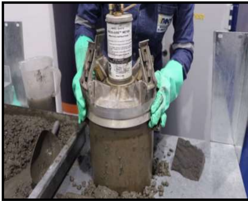
Figura 8. Ensayo de Contenido de aire
