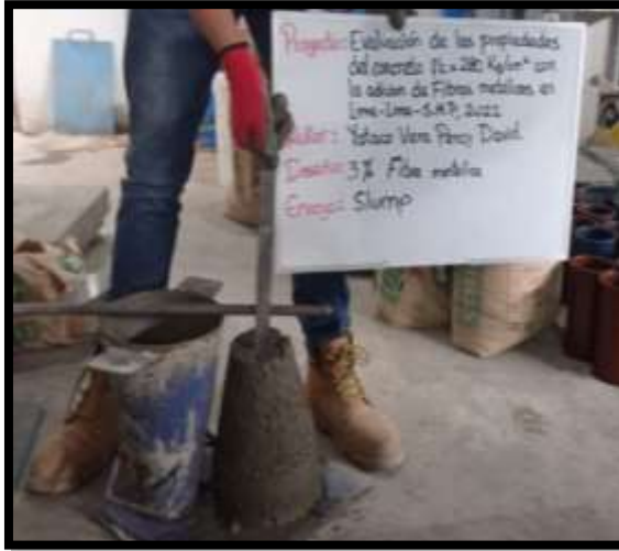
Figura 29. Ensayo de asentamiento
