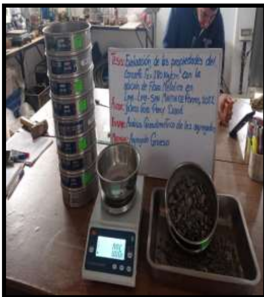
Análisis granulométrico Agregado grueso
