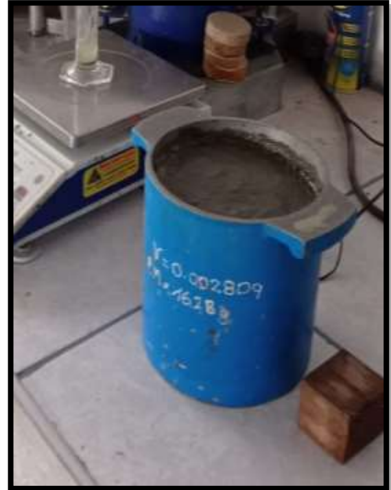
Figura 42. Recipiente para la medición del ensayo de exudación
