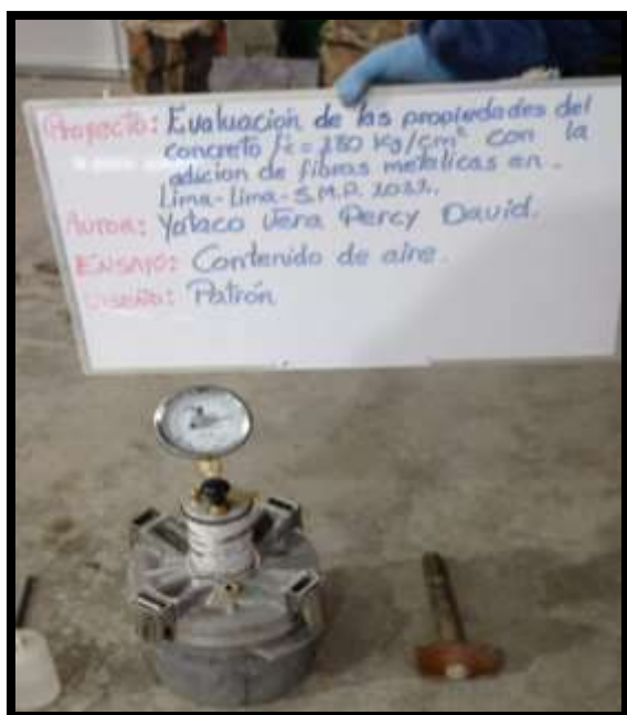
Figura 38. Ensayo de contenido de aire en el concreto
