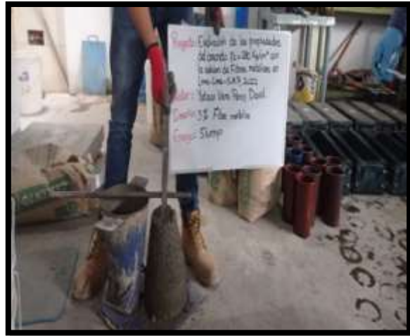
Ensayo de asentamiento
