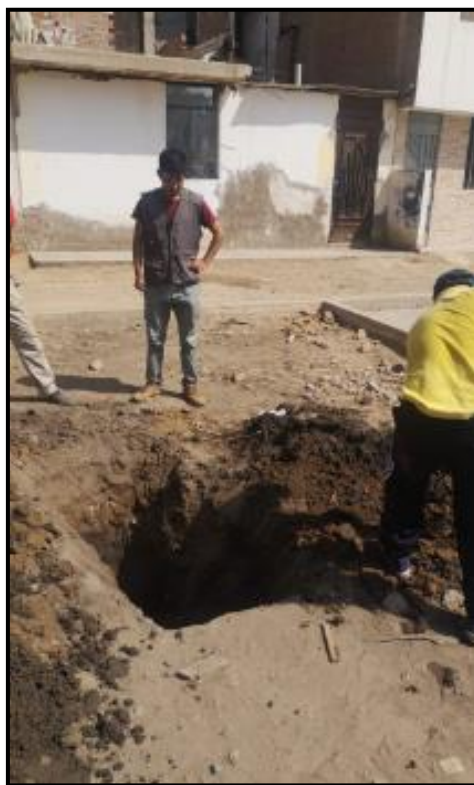
FOTO N° 10: CALICATA N°10.- Ubicada en la Intersección de calle NN - 243 con calle NN - 250 -Coordenadas 9252687.586 N-625484.969 E
