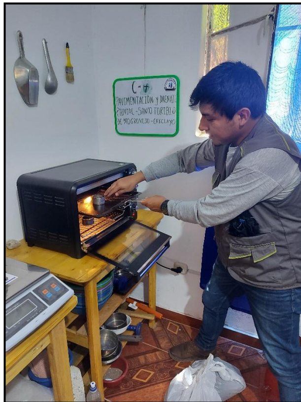
FOTO N° 18: Secado de la muestra representativa de la masa de suelo en el horno del laboratorio.
