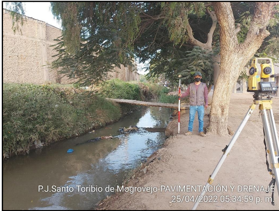
FOTO N° 22: Toma de puntos en los bordes de la acequia Cois.
