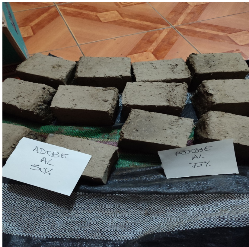
Fig. 20. Ensayos de Resistencia a la Compresión de los especímenes
