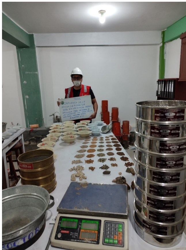
Fig. 12. Bowls con material esféricos para determinar Limites de Atterberg
