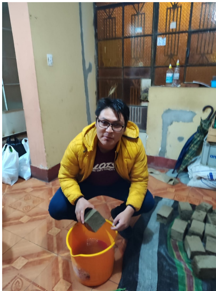
Fig. 21. Sumergiendo las muestras por 24 horas para el ensayo de absorción.
