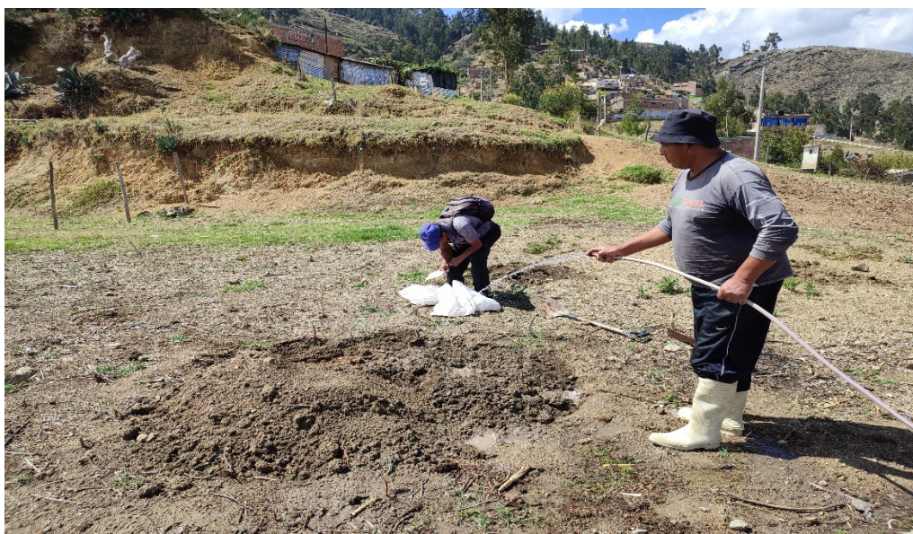
Fig. 15. Adición de la Fibra de Yute( 0.25%,0.50% y 0.75%) en la Mezcla de agua y tierra
