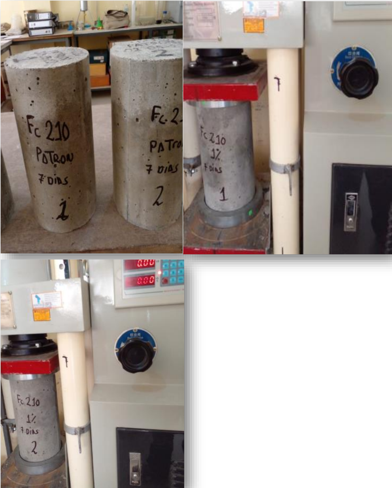
Rotura de Briguetas a los 7 días.
