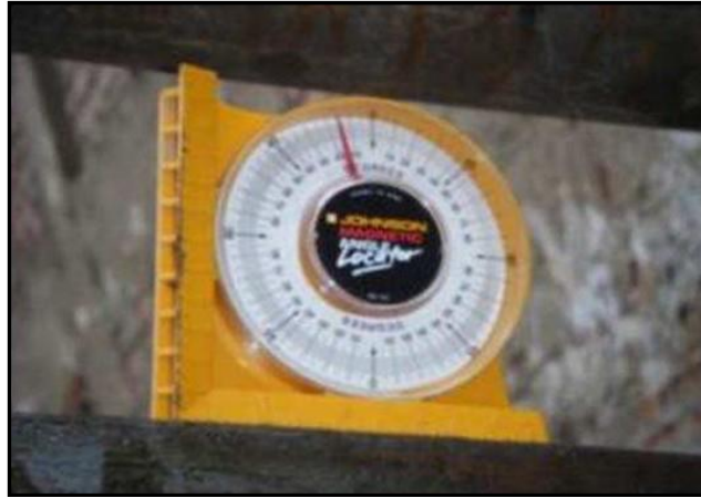
Figura 10. Medición de ángulo de perforación
