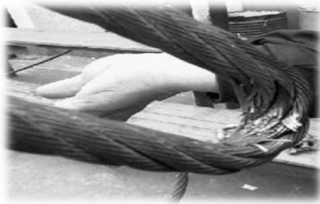
Figura 6. *Presencia de desgaste de accesorios de izajes*
