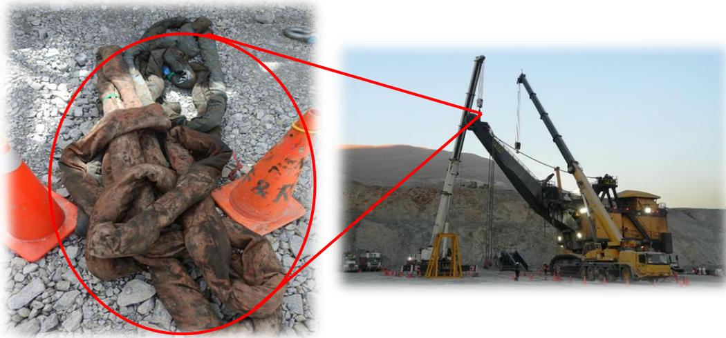
Figura 4. *Eslingas con presencia de contaminación por grasa*
