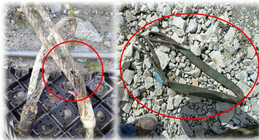
Figura 5. *Eslingas con deterioro por contaminación y fatiga*
