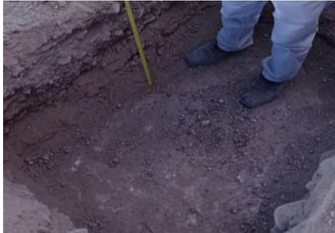
Imagen 29. Calicata 03 al lado del reservorio en terreno natural
