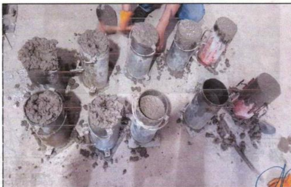
Realización de moldeo patrón de probetas de 15 x 30 cm – Hormigón concreto método de ensayo normalizado para la determinación de la resistencia a la compresión del concreto en muestras cilíndricas. NTP 339.034 – 2008
