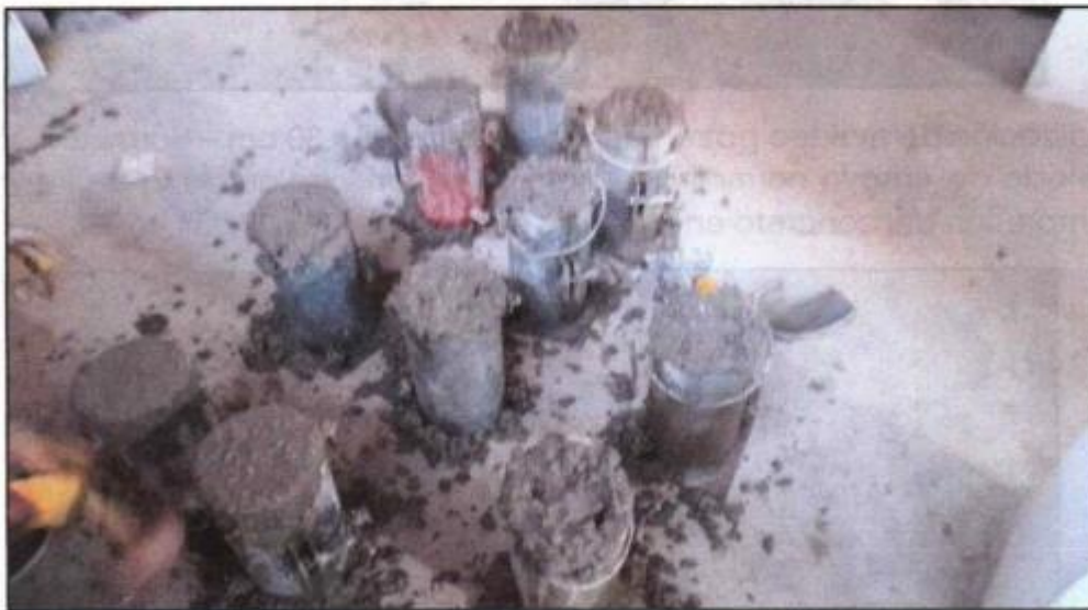
Realización de moldeo patrón de probetas de 15 x 30 cm – Hormigón concreto método de ensayo normalizado para la determinación de la resistencia a la compresión del concreto en muestras cilíndricas. NTP 339.034 - 2008
