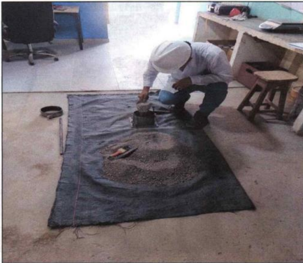
Realización de ensayo de peso volumétrico suelto y peso volumétrico compactado NTP-400.017-2011 (Agregados) Método de Ensayo Para Determinar El Peso Unitario Del Agregado
