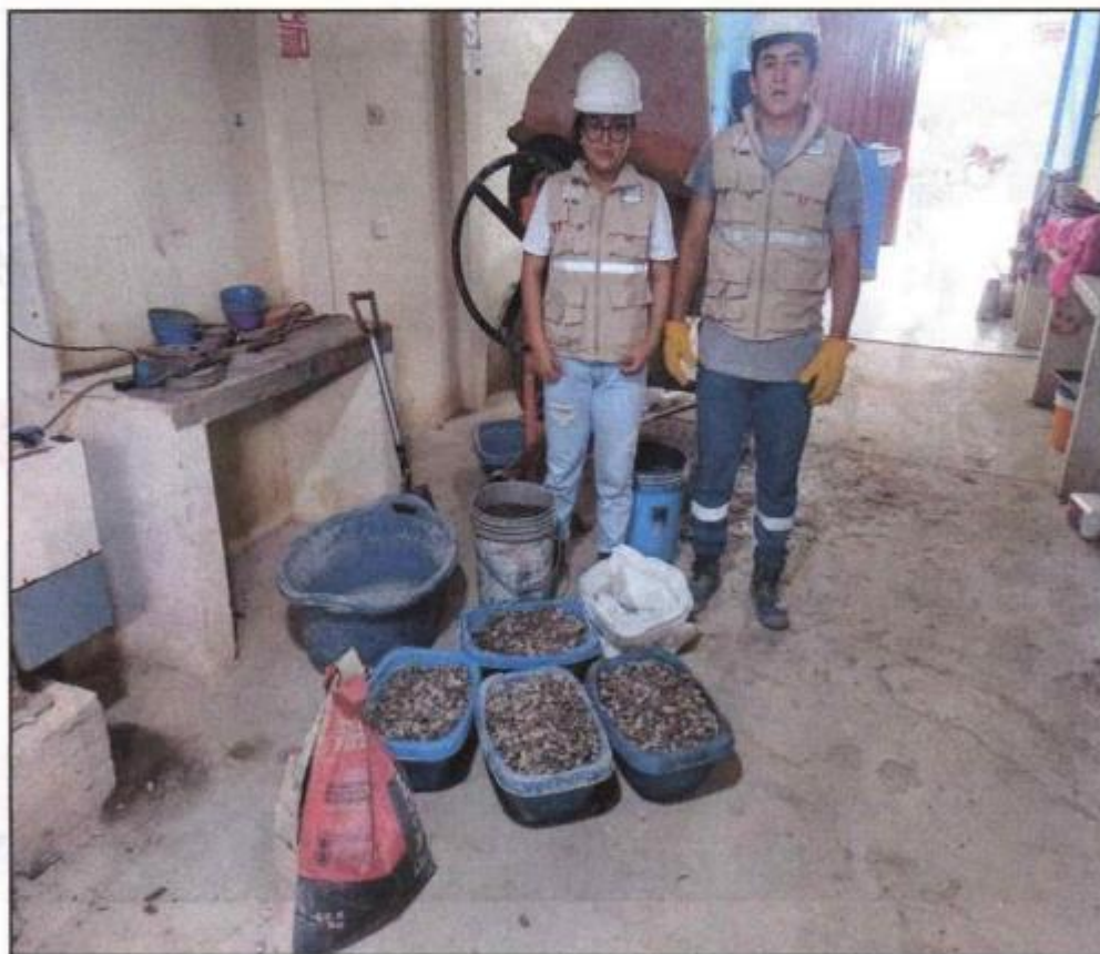
Preparación y pesado de los agregados para la elaboración de los cilindros de concreto.
