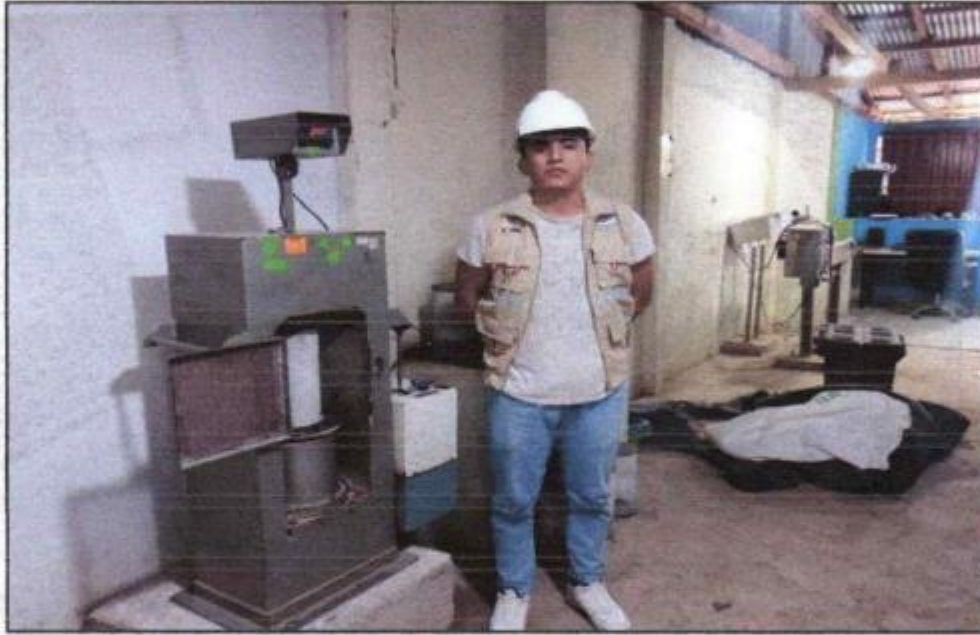
Realización de ensayo normalizado para la determinación de la resistencia a la compresión del concreto en muestras cilíndricas. NTP 339.034 - 2008
