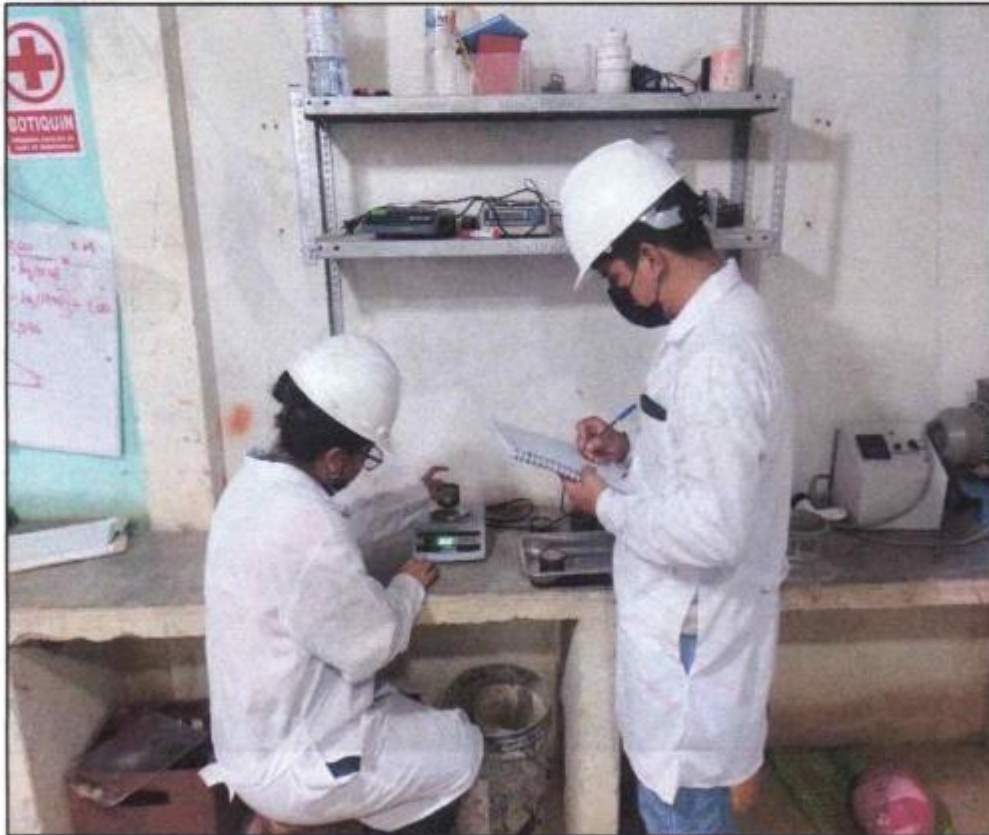
Proceso de toma de muestra para el ensayo de humedad natural, humedad constante a 110^{\circ}\text{C} , - Ensayo de Contenido de Humedad NTP 339.127.
