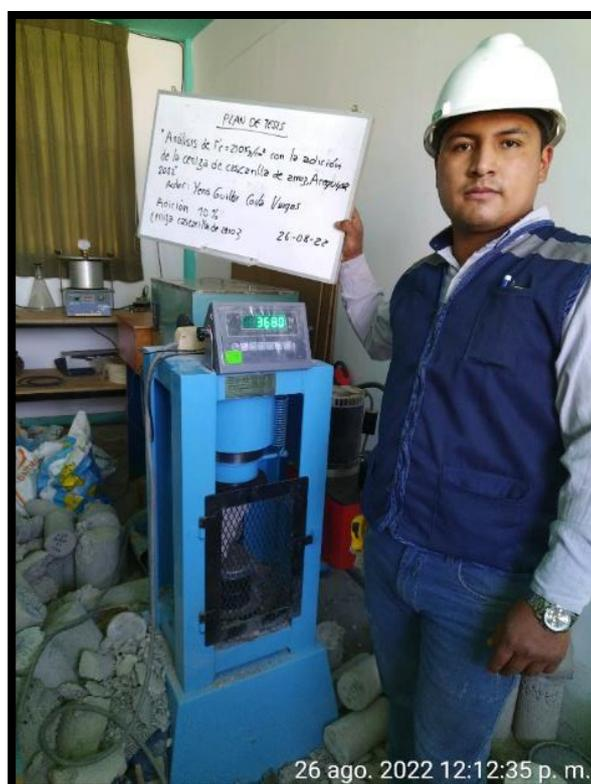
Nota: Se procedió con la rotura de las briquetas a los 14 días de curado con la muestra que tiene la adición del 10% de incineración de la cascarilla de arroz
