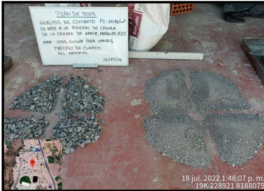
Nota: Se puede apreciar el proceso de cuarteo para empezar a realizar los ensayos correspondientes.
