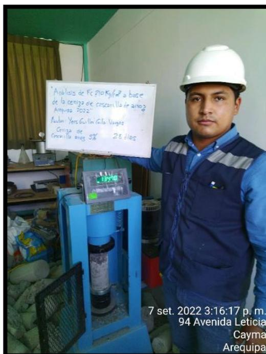
Nota: Se procedió con la rotura de las briquetas a los 28 días de curado con la muestra que tiene la adición del 5% de incineración de la cascarilla de arroz
