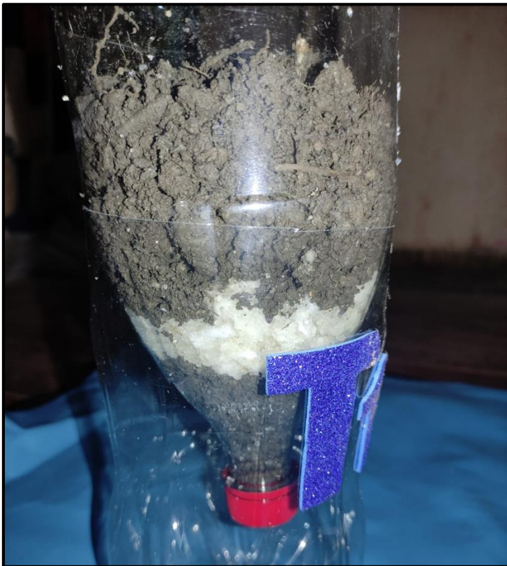
Figura 15: Acondicionamiento del hidrogel y la muestra de suelo.
