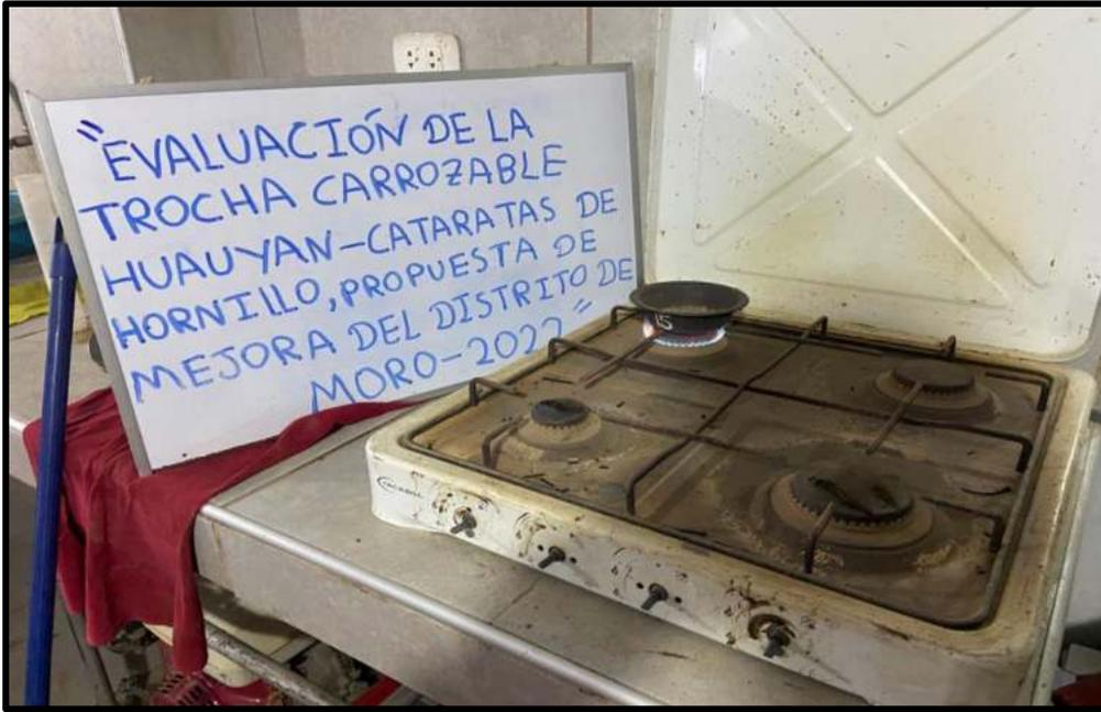
Secado de la muestra para contenido de Humedad
