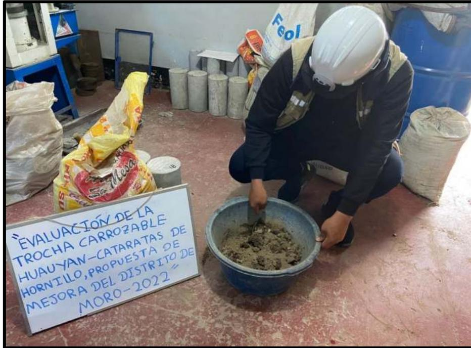
Mesclado de la muestra hasta obtener una consistencia
