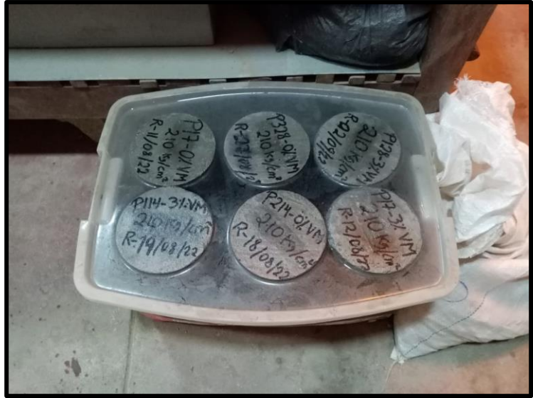
Figura 26. Proceso de desmoldado y curado de las probetas cilíndricas de concreto Fuente: Elaboración propia – Trabajo de Tesis
