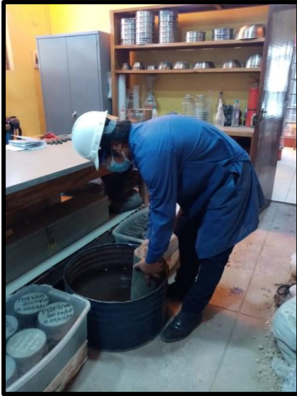
Figura 26. Proceso de desmoldado y curado de las probetas cilíndricas de concreto Fuente: Elaboración propia – Trabajo de Tesis
