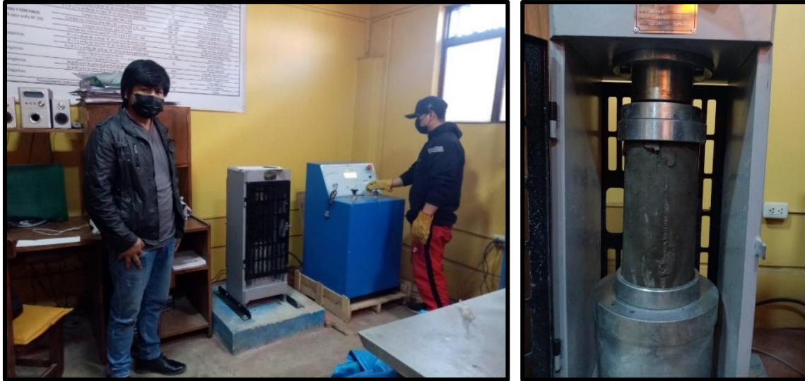
Figura 28. Proceso de rotura a compresión de las probetas cilíndricas de concreto, curadas a 7, 14 y 28 días
