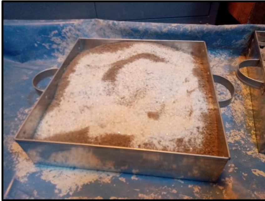
Figura 24. Proceso de mezclado del vidrio reciclado molido con el agregado fino Fuente: Elaboración propia – Trabajo de Tesis
