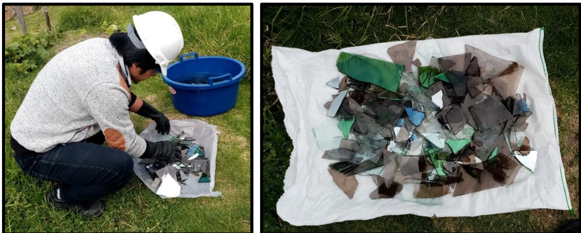
Figura 16. Selección, lavado y secado del vidrio reciclado
