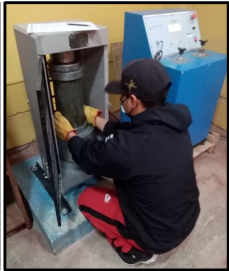
Figura 27. Proceso de retiro y colocado de las probetas curadas para el ensayo de resistencia a la compresión
