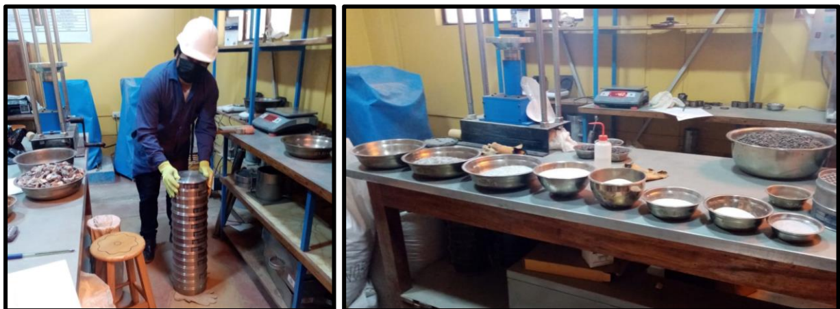
Figura 20. Proceso de tamizado de los agregados para análisis granulométrico
