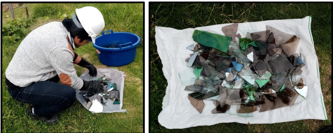
Figura 16. Selección, lavado y secado del vidrio reciclado
