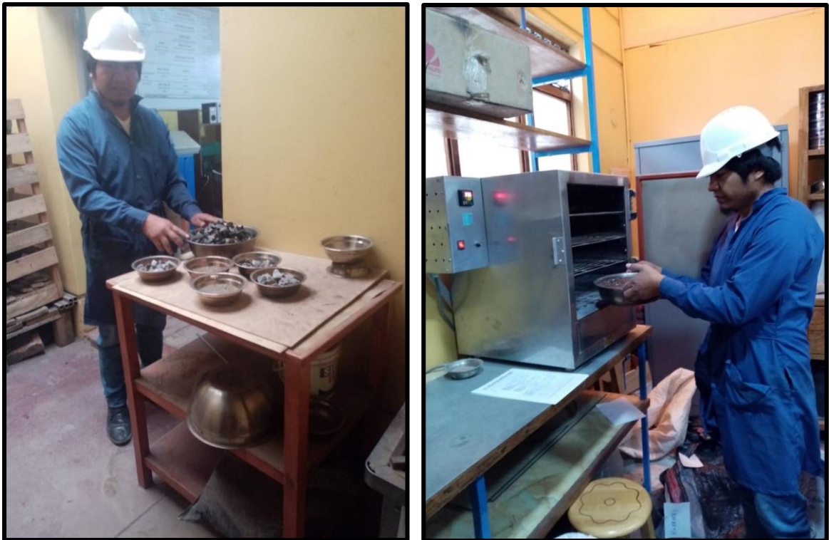
Figura 19. Proceso de secado de los agregados en el horno
