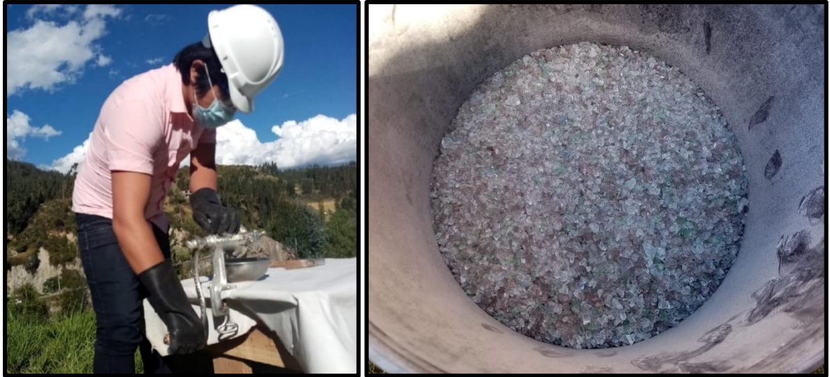
Figura 17. Proceso de molienda del vidrio reciclado con molino mecánico
