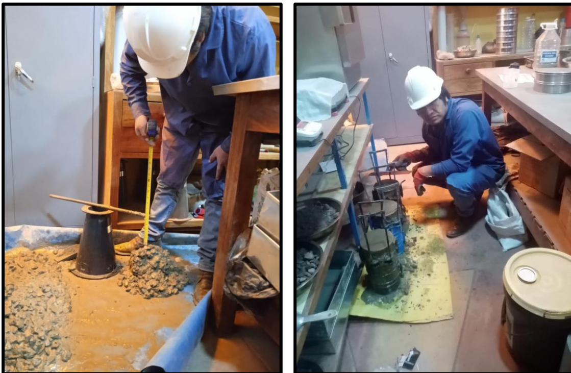
Figura 25. Preparación de mezclas de concreto, medición de asentamiento y elaboración de probetas cilíndricas Fuente: Elaboración propia – Trabajo de Tesis
