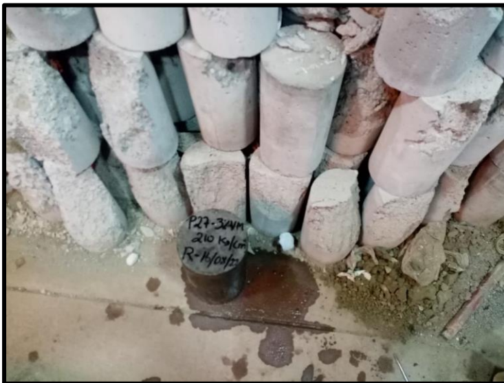
Figura 27. Proceso de retiro y colocado de las probetas curadas para el ensayo de resistencia a la compresión
