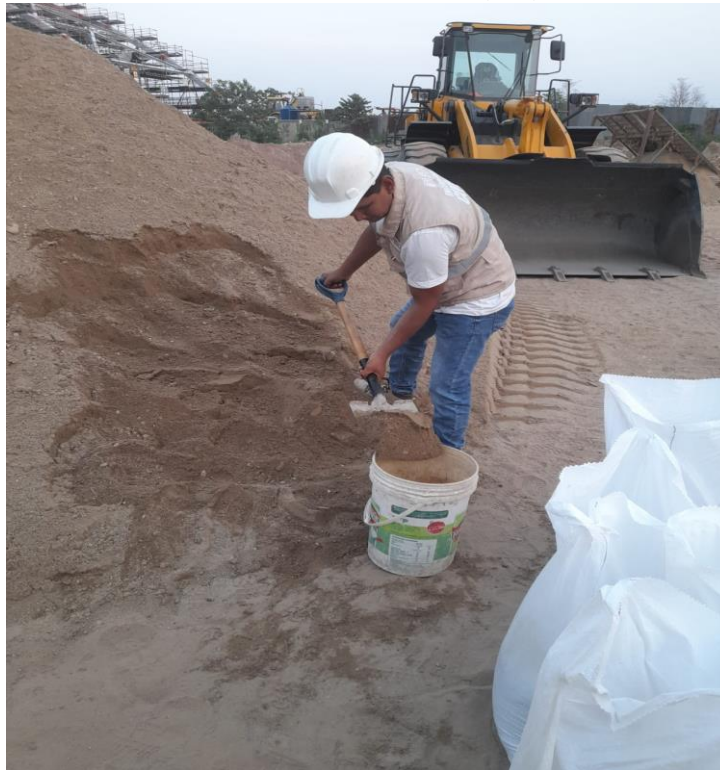
FOTO N°01: Extracción del Agregado Fino.
