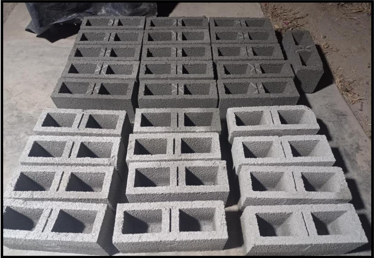
FOTOGRAFIA 22 Curado de los bloques de concreto
