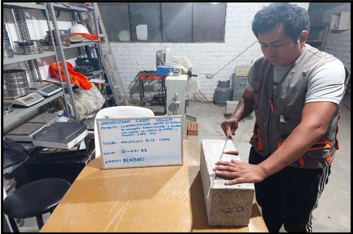
FOTOGRAFIA 28 Ensayo de alabeo de los bloques de concreto a los 28 días
