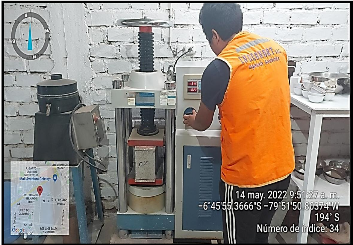
FOTOGRAFIA 24 Ensayo de resistencia a la compresión de la unidad f'b a los 14 días
