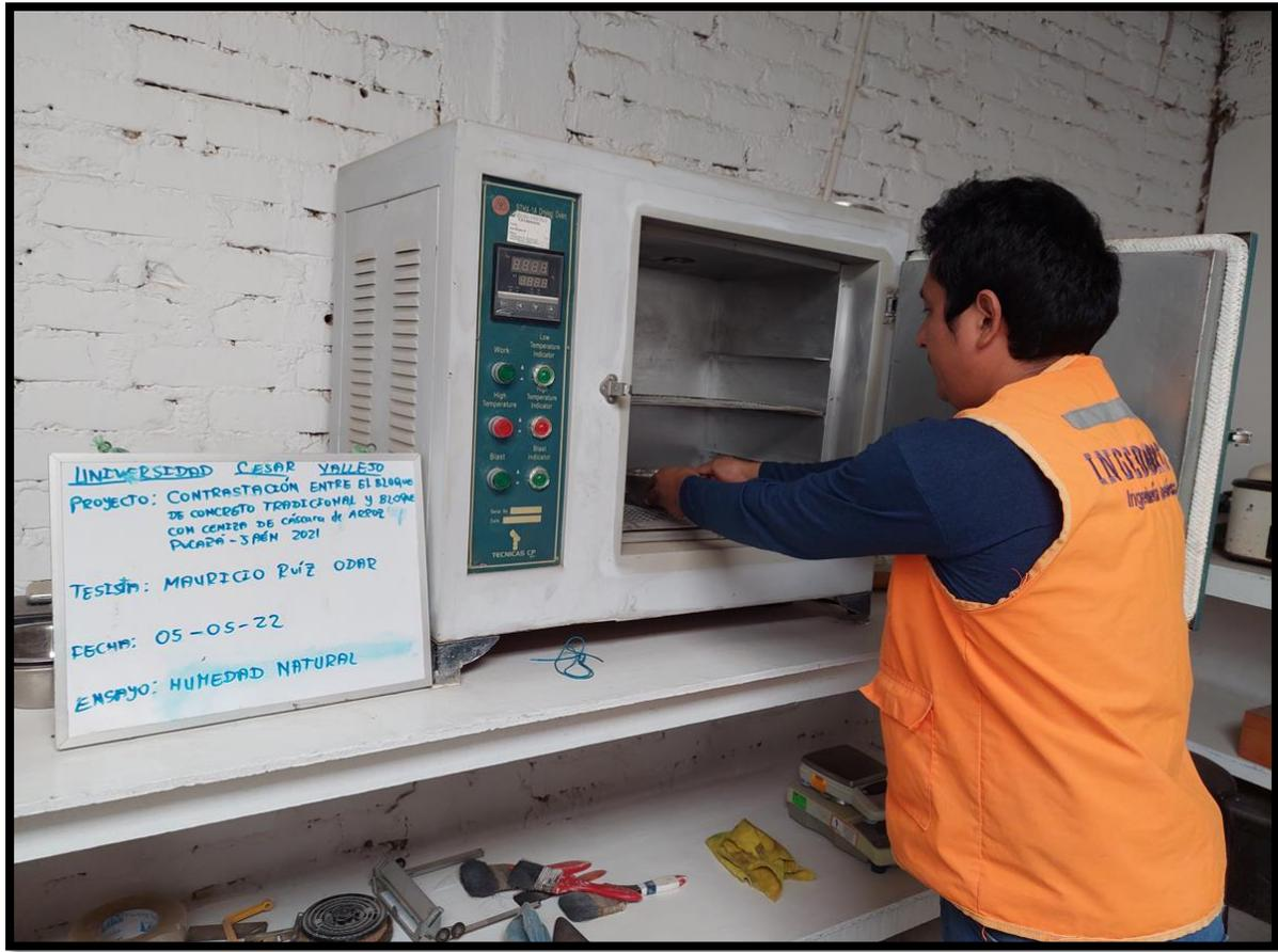
FOTOGRAFIA 12 Ensayo de peso específico de la arena
