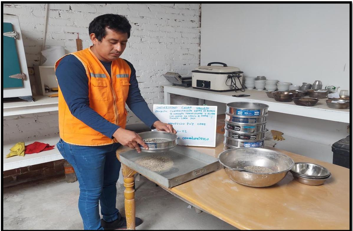
FOTOGRAFIA 11 Ensayo de humedad natural del agregado fino
