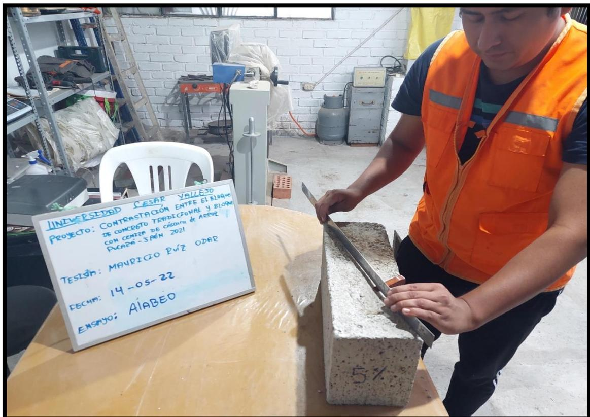
FOTOGRAFIA 27 Ensayo de alabeo de los bloques de concreto a los 14 días
