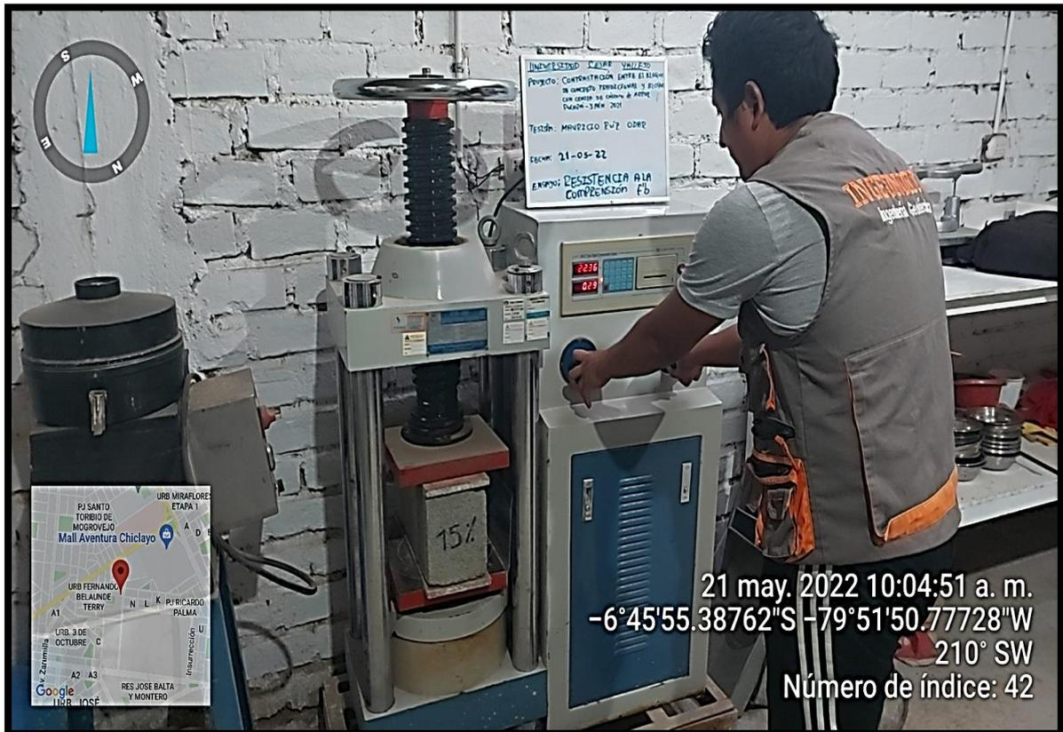
FOTOGRAFIA 25 Ensayo de resistencia a la compresión de la unidad f'c a los 28 días
