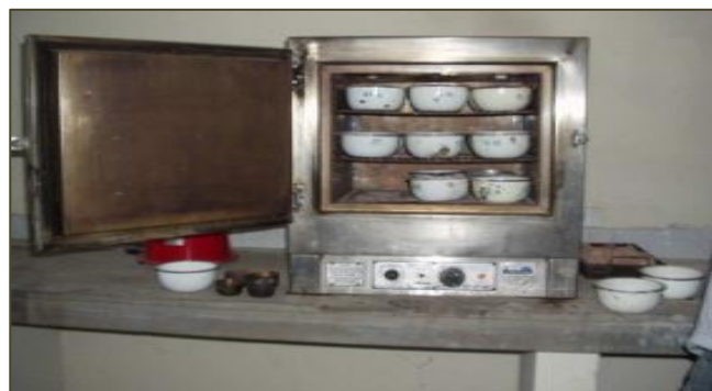
Figura 8. Materiales para el ensayo de humedad Fuente. Geotechnical Consulting
