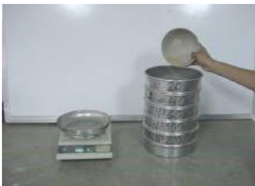
Figura 6. Materiales para el ensayo de granulometría
