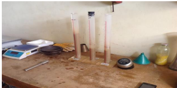
Figura 9. Materiales para el ensayo de equivalente de arena
