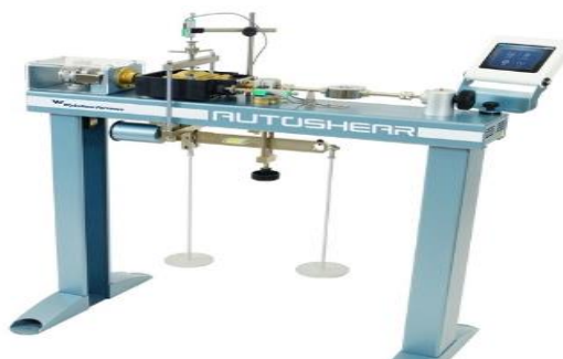
Figura 13. Máquina de ensayo para corte directo
