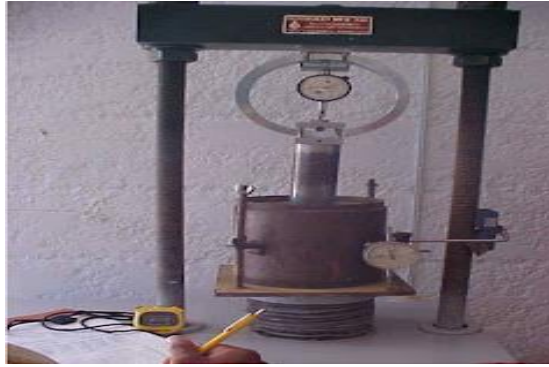
Figura 10. Máquina para ensayo de CBR
