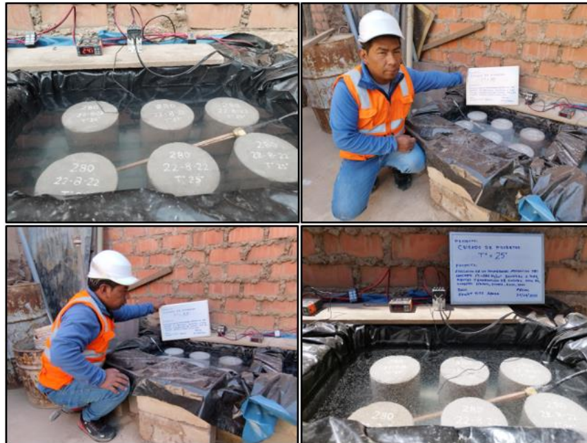
Figura 9. Proceso de curado del concreto en diferentes temperaturas
