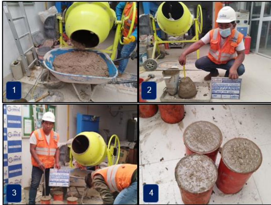
Figura 7. Proceso de mezcla y vaciado de concreto
