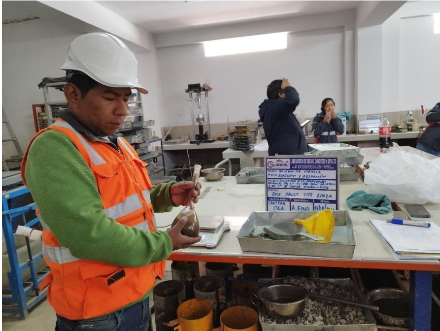
Fotografía 3. Realizando el ensayo de peso específico y absorción
