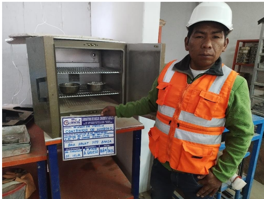
Fotografía 4. Realizando el ensayo de contenido de humedad
