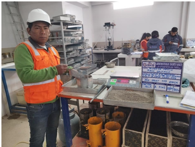
Fotografía 2. Realizando el ensayo de peso unitario
