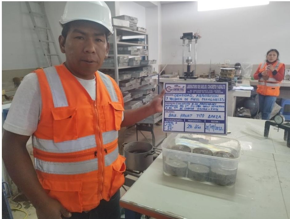
Fotografía 11. Realizando el ensayo de densidad y absorción del concreto
