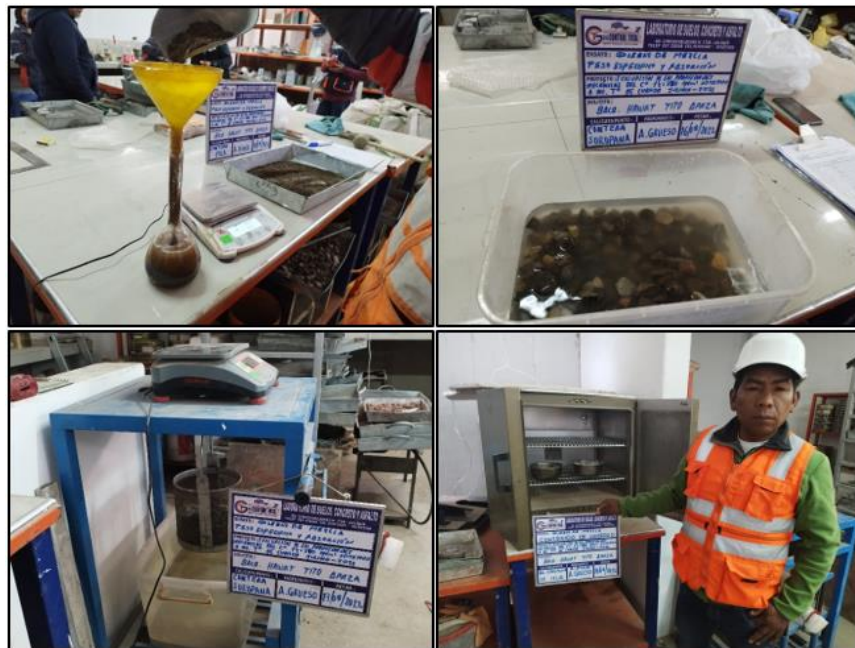
Figura 6. Proceso de peso específico, absorción y contenido de agua
