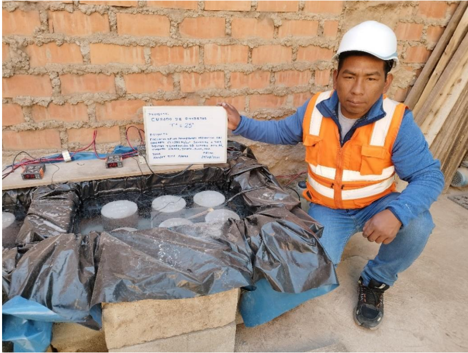
Fotografía 9. Controlando el curado del concreto en 25°C
