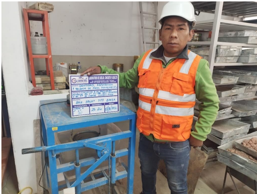
Fotografía 10. Realizando el ensayo de volumen de vacíos
