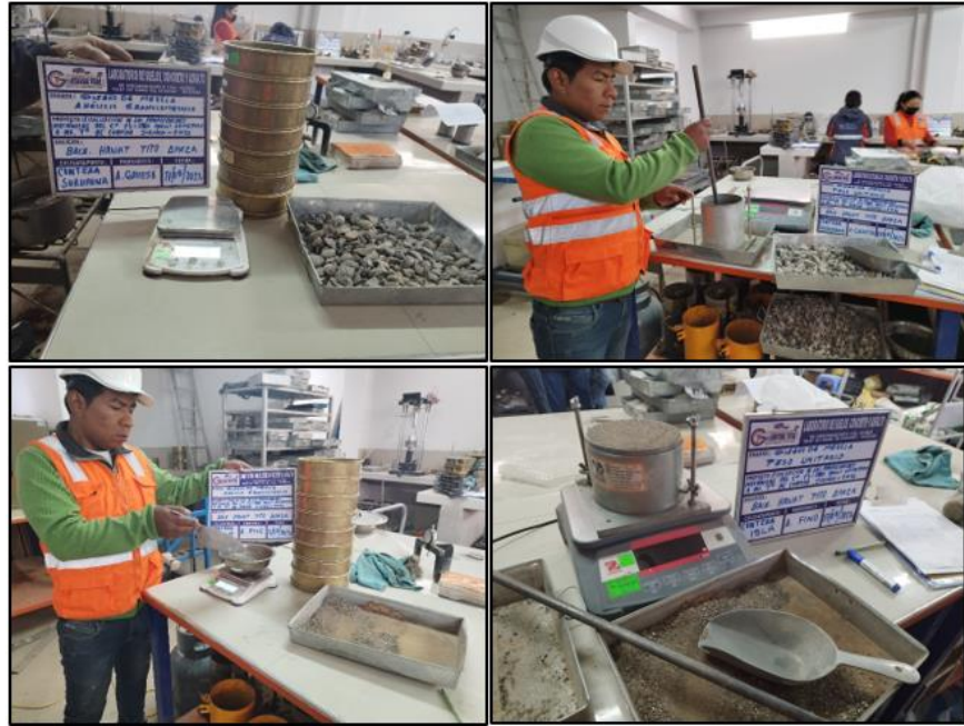
Figura 5. Proceso de granulometría y peso unitario suelto y compacto
