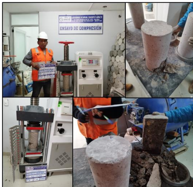
Figura 11. Resistencia a la compresión del concreto en diferentes temperaturas
