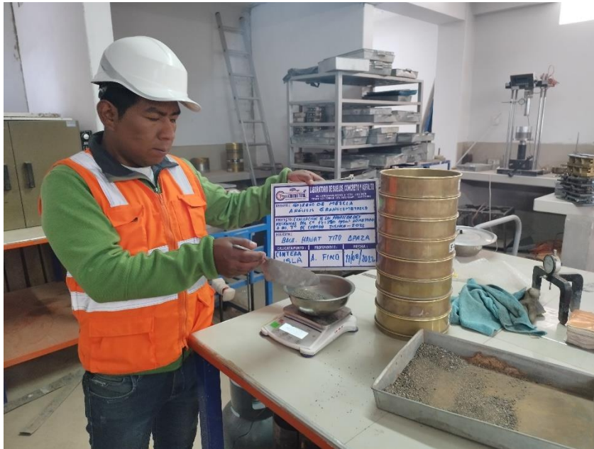
Fotografía 1. Realizando el ensayo de granulometría de agregados
