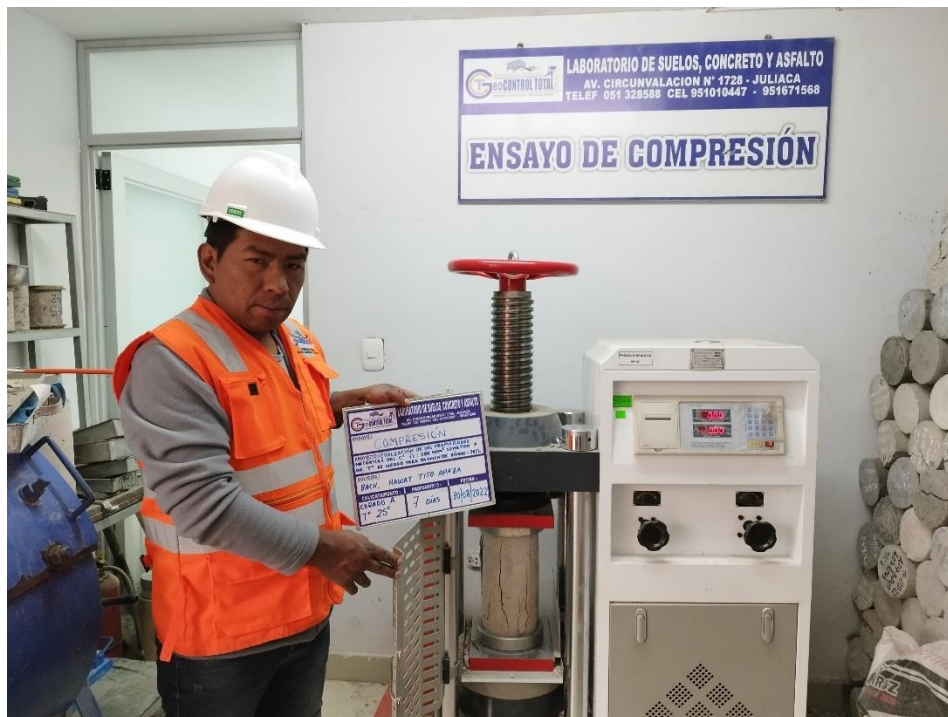
Fotografía 12. Realizando el ensayo a la compresión del concreto
