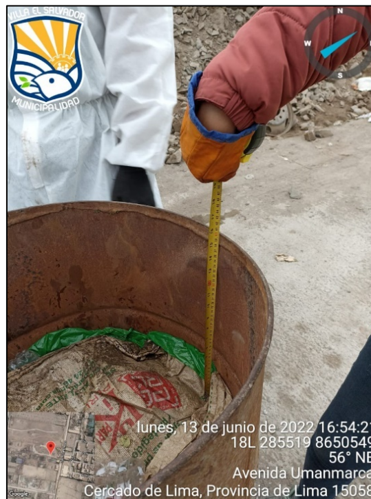
Imagen N° 03: Medición del volumen de las muestras de residuos sólidos domiciliario
