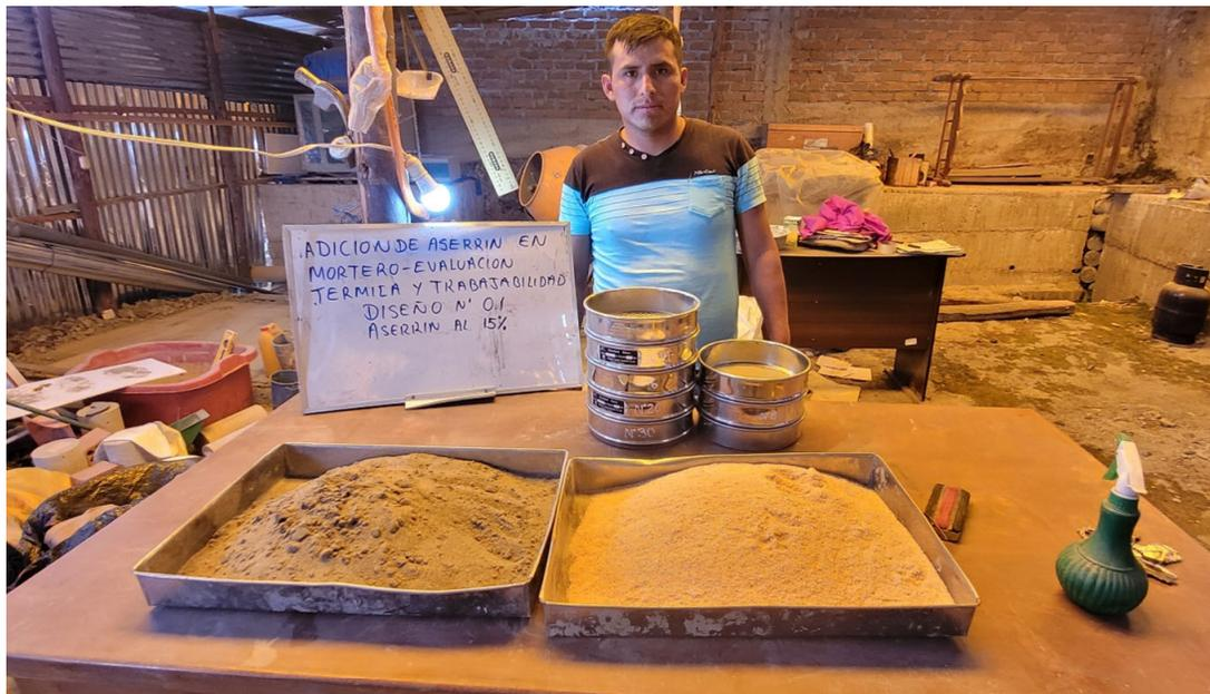
En el laboratorio con la muestra de adición al 15% de aserrín.
