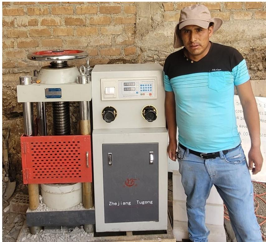
La prensa para la ruptura de las briquetas
