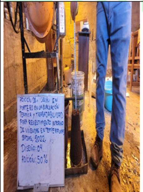
DISEÑO DE MEZCLA DE MORTERO CON ADICION DE 50% DE ASERRIN
