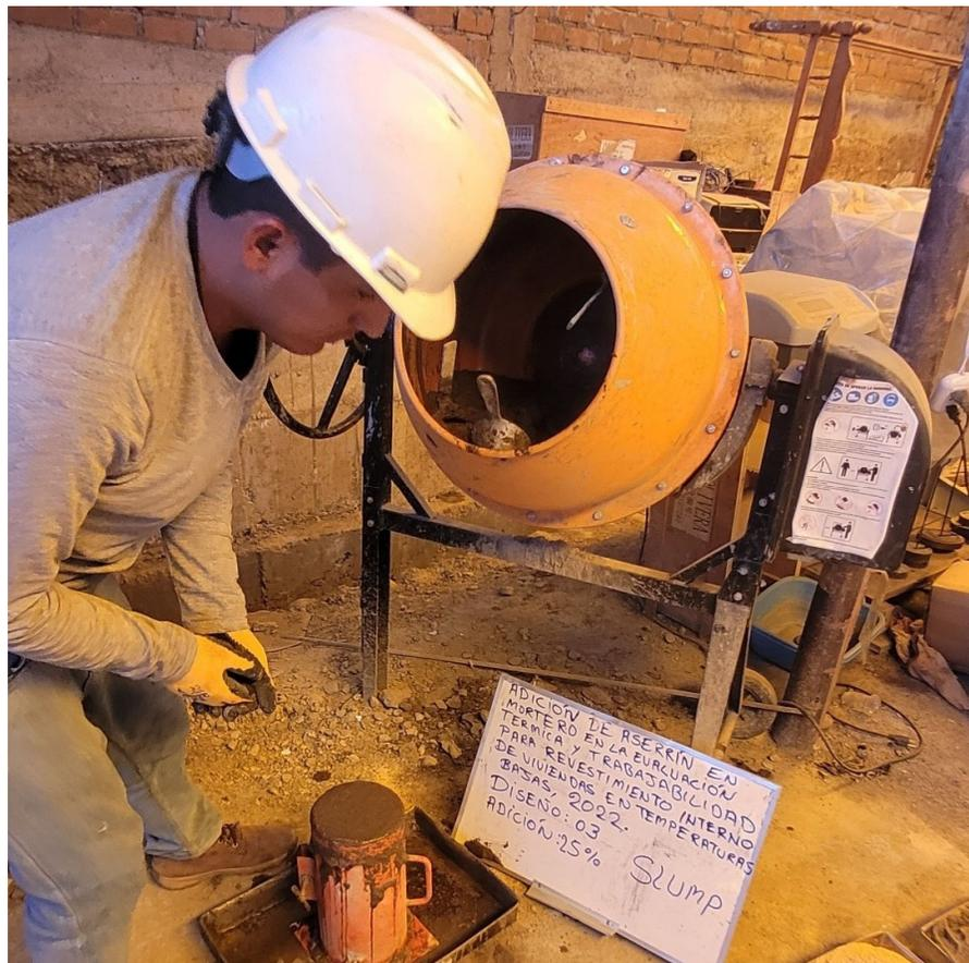
Realizando la probeta para el ensayo de resistencia.
