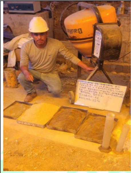
DISEÑO DE MEZCLA DE MORTERO CON ADICION DE 15% DE ASERRIN
