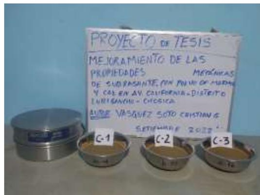
*Fig. Preparación de muestras de las calicatas para ensayo de límites de consistencia.*
