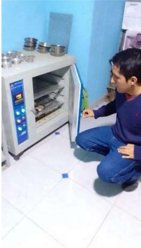
*Fig. Secado de muestras en el horno.*
