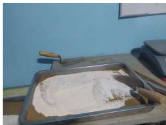
*Fig. Muestra de suelo con polvo de mármol y cal para ensayo de CBR.*
