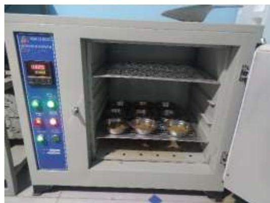
*Fig. Secado de muestras en el horno para determinar el contenido de humedad.*
