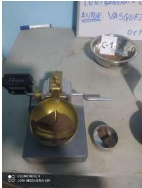
*Fig. Ensayo Casagrande de la calicata.*
