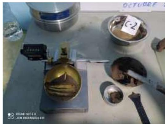
*Fig. Ensayo Casagrande de la calicata.*
