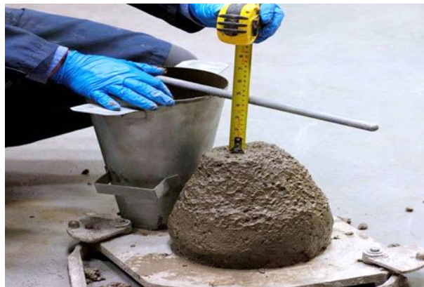
Figura 6: Asentamiento del concreto.
