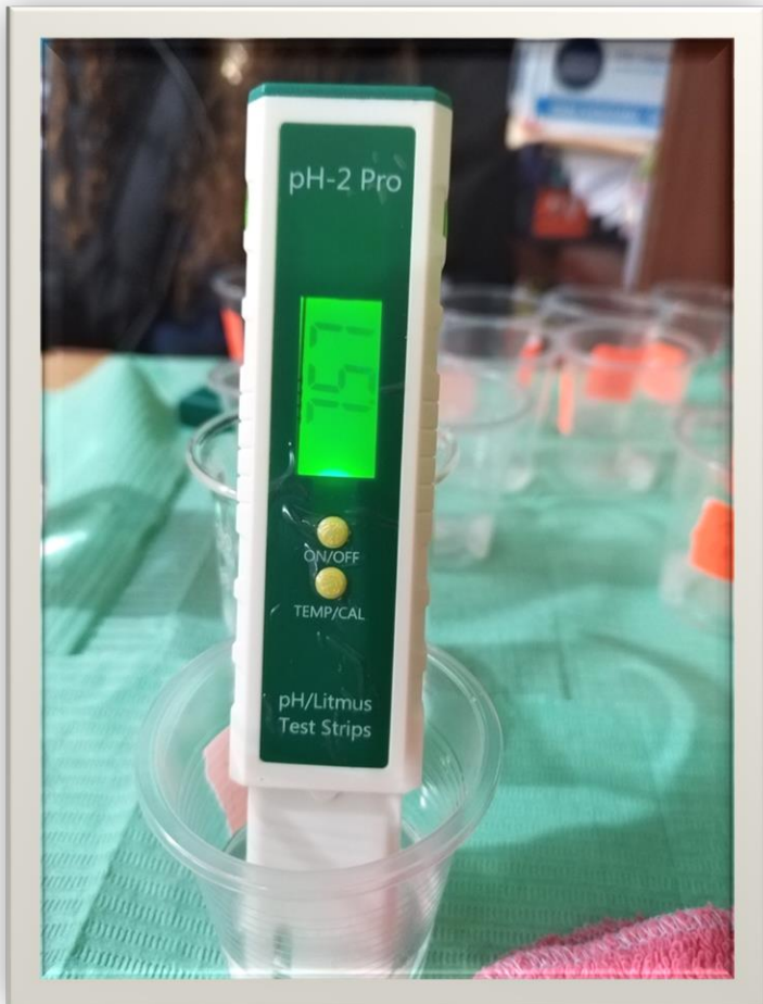
CALIBRACION DE PH - METRO
