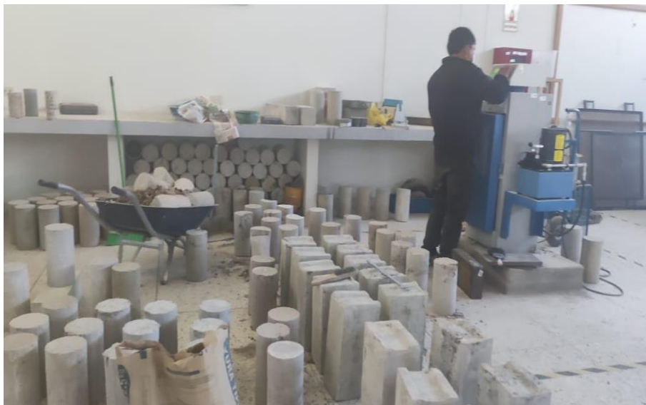
Fotografía 15 Rotura de probetas de concreto.
