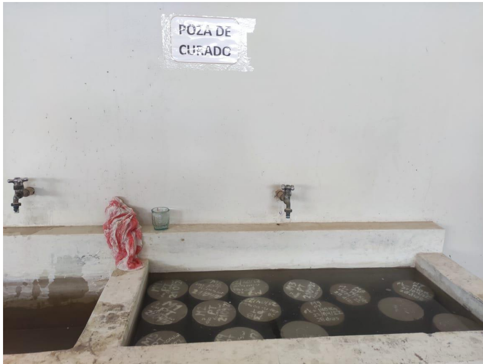
Fotografía 14 Poza de curado de concreto
