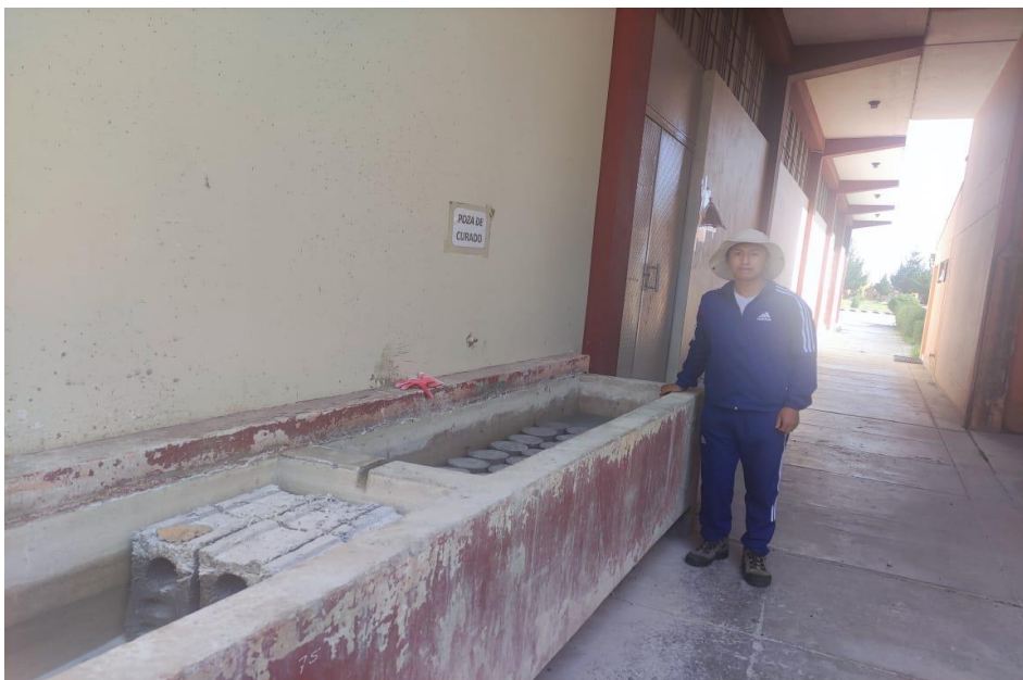
Fotografía 13 Curado de probetas de concreto.
