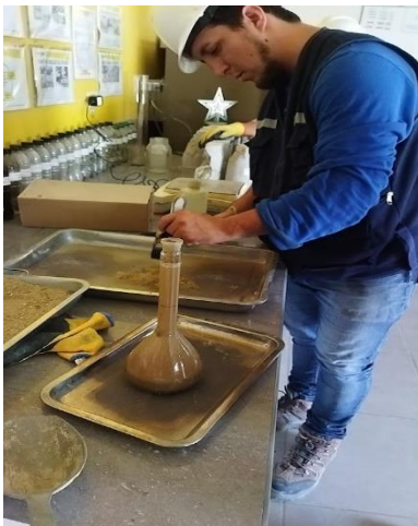
Figura 49. Ensayo de Peso específico de la Arena
