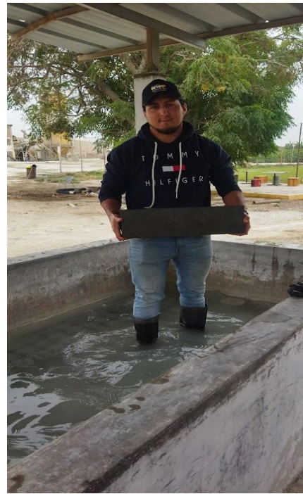
Figura 43. Curado de Viguetas para periodos de 28 y 56 días.
