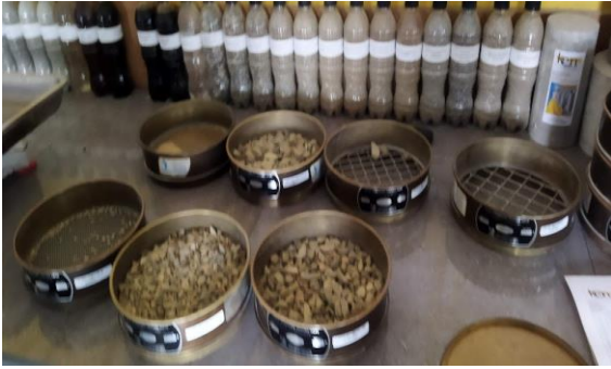
Figura 47. Tamizado del agregado Grueso.
