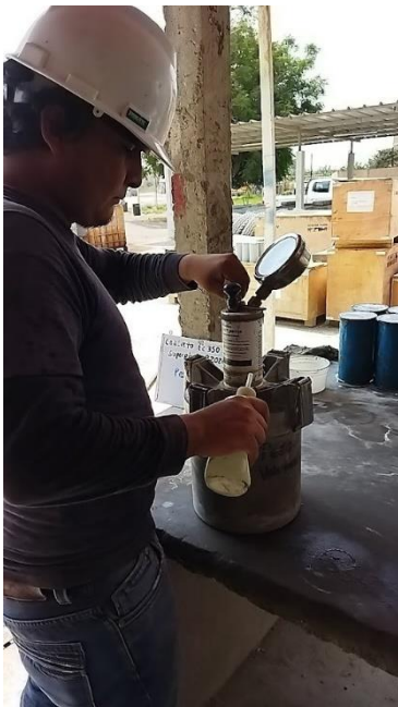
Figura 41. Contenido de Aire del concreto.
