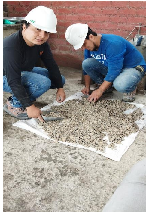
Figura 46. Cuarteo para el ensayo de Granulometría del agregado Grueso
