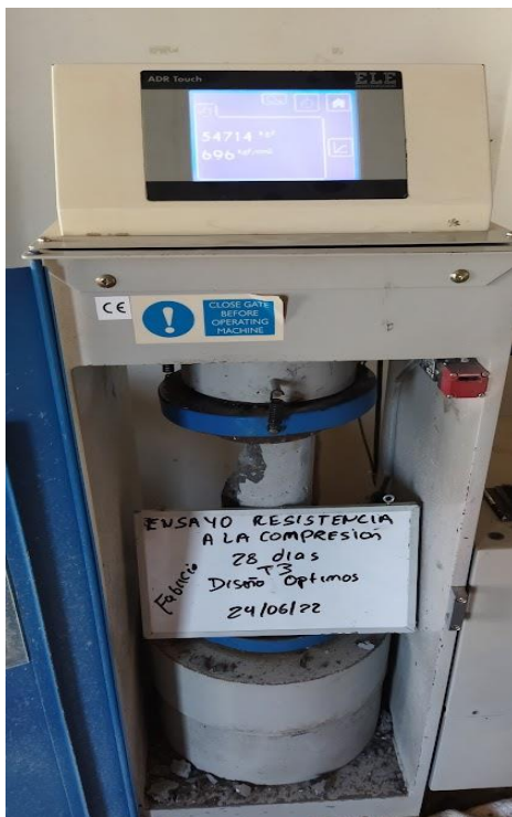
Figura 38. Resultado para un Resistencia a la compresión de f'_c = 696 \text{ kg/cm}^2
