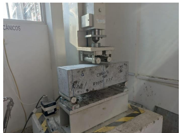
Figura 37. Resistencia a la Flexión de 4 puntos para un periodo de 56 días.
