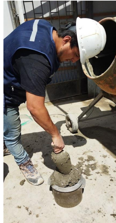
Figura 40. Ensayo de Peso Unitario del Concreto.
