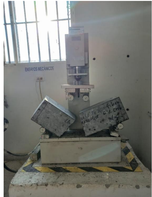
Figura 36. Ensayo de resistencia a la Flexión para un periodo de 28 días.
