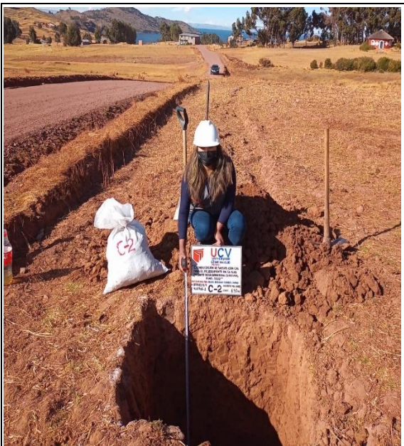
Figura 22 Excavación de calicata 2 en la carretera Capachica a Chifron.
