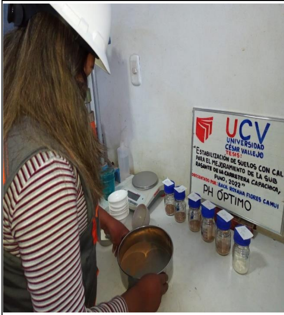
Figura 35 Realizando el ensayo de EADES & GRIM según ASTM D-6276.
