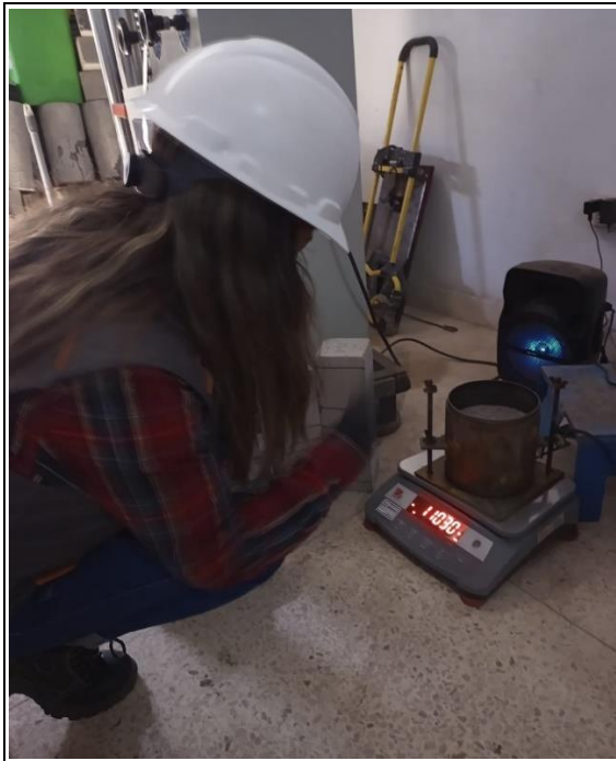
Figura 57 Peso de molde de CBR más muestra después de la inmersión.
