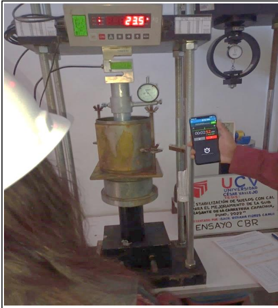
Figura 59 Realizando la lectura del ensayo de penetración CBR.
