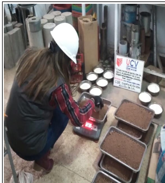
Figura 61 Dosificación de la muestra con cal en 4%, 6% y 8% para el CBR.
