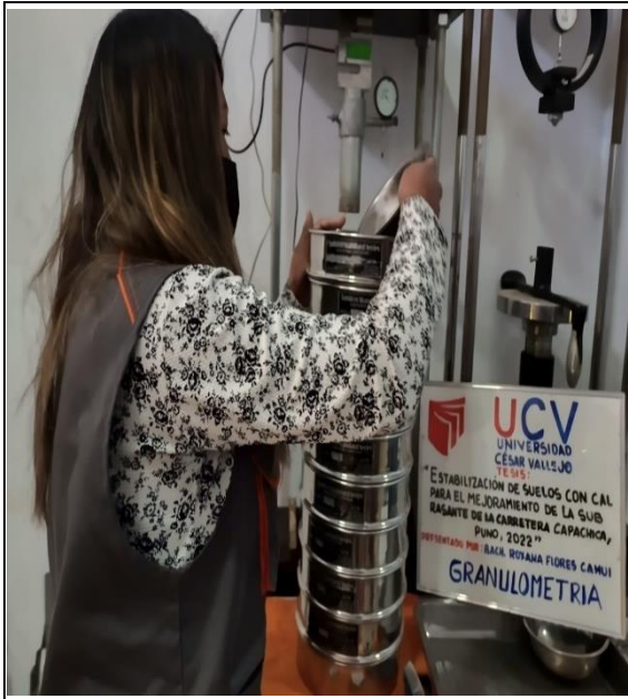
Figura 31 Realizando ensayo de análisis granulométrico por tamizado.
