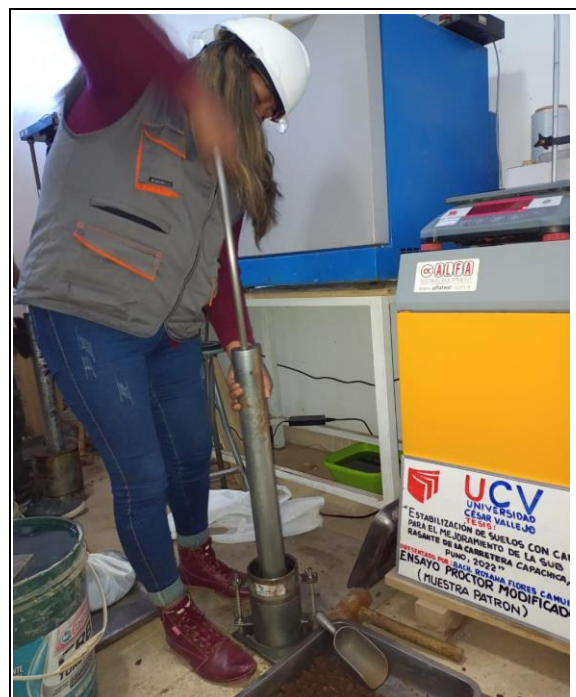
Figura 46 Ensayo proctor modificado con el método A para la muestra patrón.
