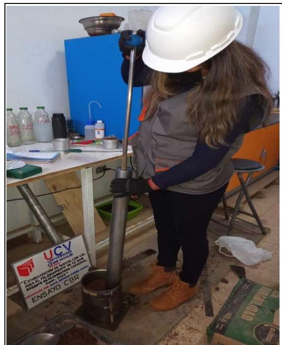
Figura 52 Ensayo de CBR muestra patrón compactando en 5 capas.
