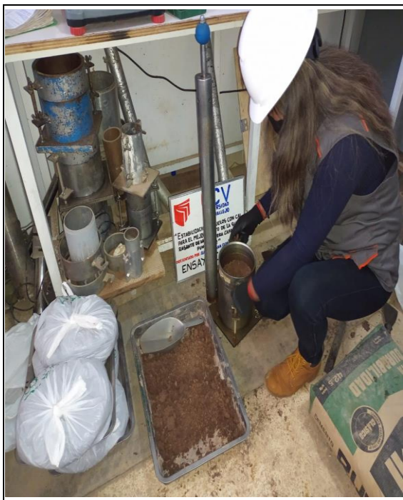
Figura 53 Proceso de realización del ensayo de CBR muestra patrón.
