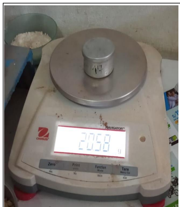
Figura 42 Peso de tara más muestra ensayo de límite líquido.
