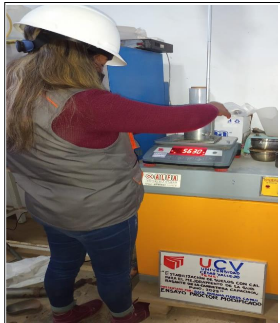
Figura 48 Peso del molde más muestra compactada del proctor.
