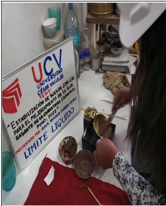
Figura 39 Ensayo de límite líquido para muestra patrón.
