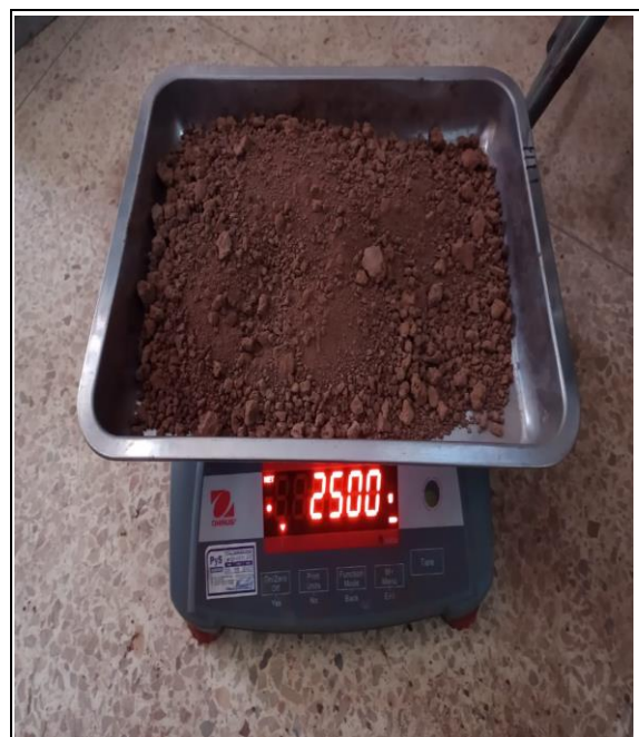
Figura 50 Peso de muestra patrón para la realización del ensayo de CBR.
