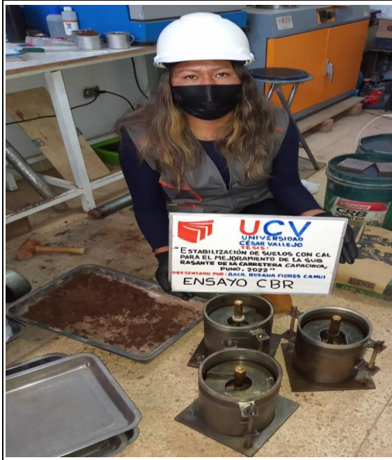
Figura 55 Proceso de realización del ensayo de CBR muestra patrón.
