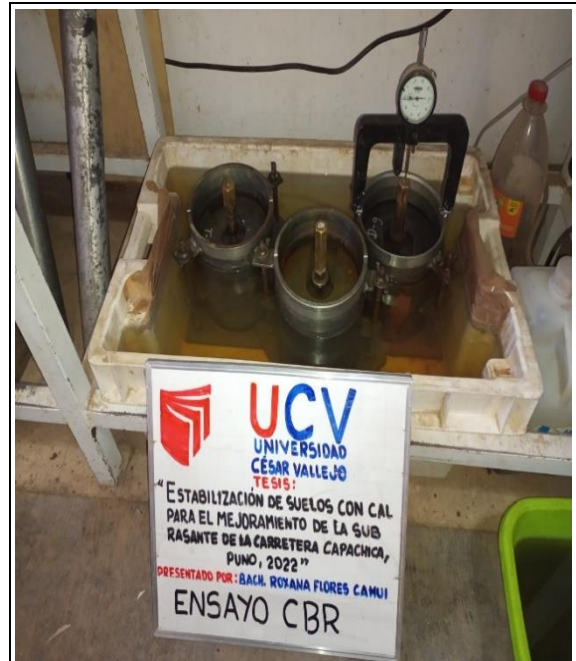
Figura 56 Inmersión en tanque de agua por 4 días leyendo cada 24 hrs.
