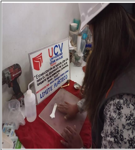
Figura 43 Ensayo de límite plástico para la muestra patrón.
