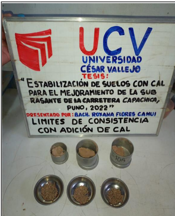
Figura 45 Límites de consistencia con adición de cal de 4%, 6% y 8%.
