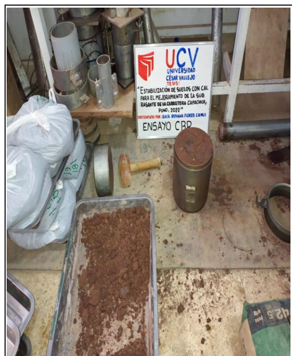
Figura 54 Proceso de enrasado de la muestra patrón.
