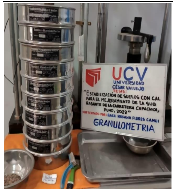
Figura 32 Juego de tamices para determinar la granulometría.
