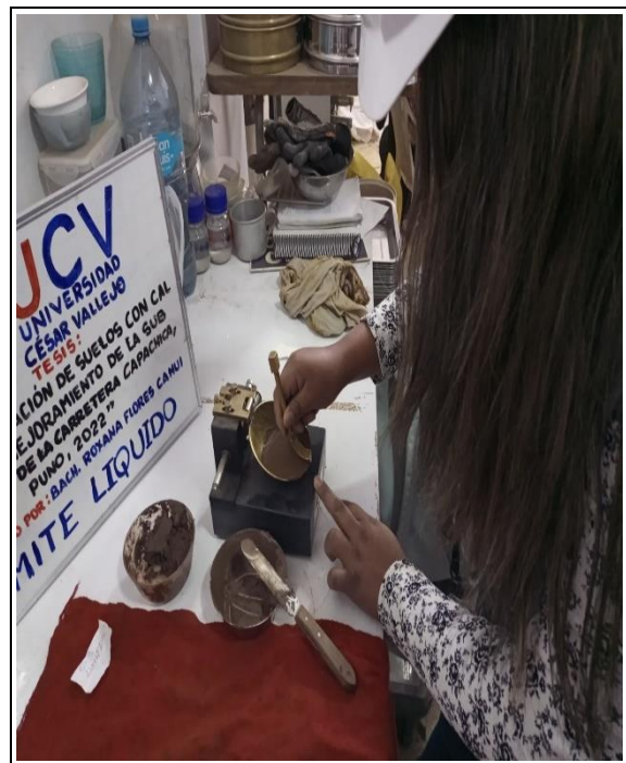
Figura 40 Ranurando para la muestra patrón con la cuchara de casagrande.
