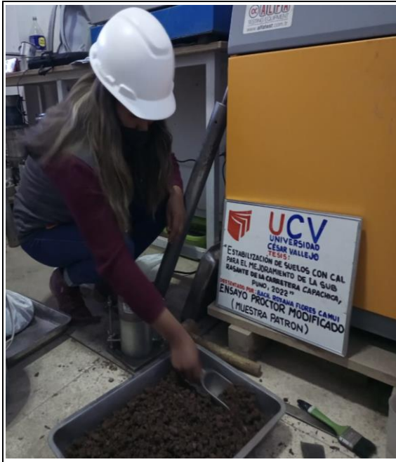
Figura 47 Proceso de llenado de la muestra al molde del proctor modificado.
