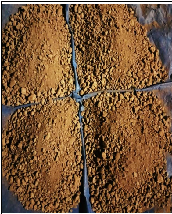
Figura 29 Cuarteo de la muestra ya secado al ambiente.
