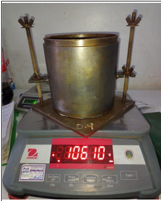
Figura 51 Pesando el molde del CBR.
