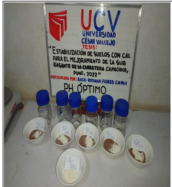
Figura 36 Mezclado de muestra y cal con diferentes porcentajes.
