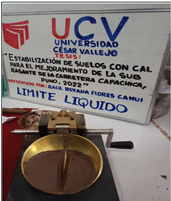
Figura 41 Cerrado de abertura en 25 golpes con la cuchara de casagrande.
