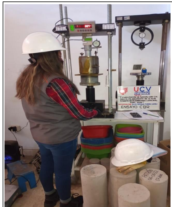
Figura 58 Ensayo de penetración CBR en la prensa hidráulica.
