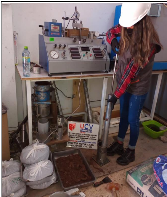
Figura 49 Ensayo proctor modificado con adición de cal 4%, 6% y 8%.
