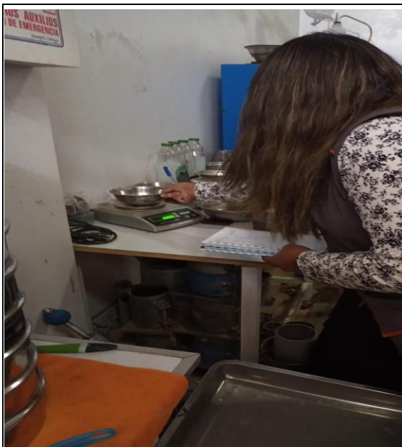
Figura 33 Peso de tara para el ensayo de granulometría.
