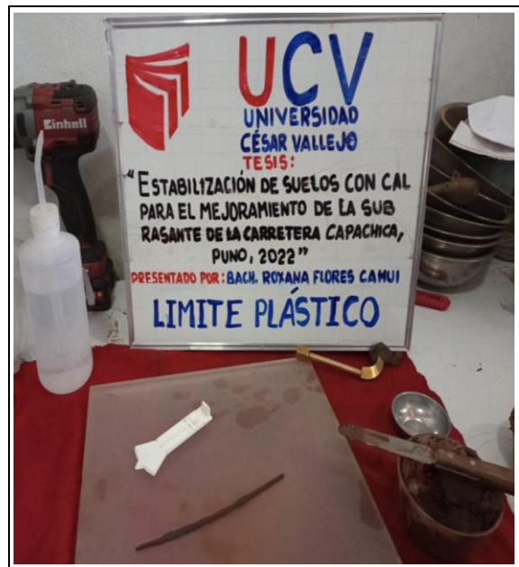
Figura 44 Realizando barritas de suelo con diámetro de 3mm.
