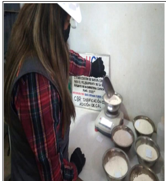
Figura 60 Peso de cal 4%, 6% y 8% para realizar el ensayo de CBR.
