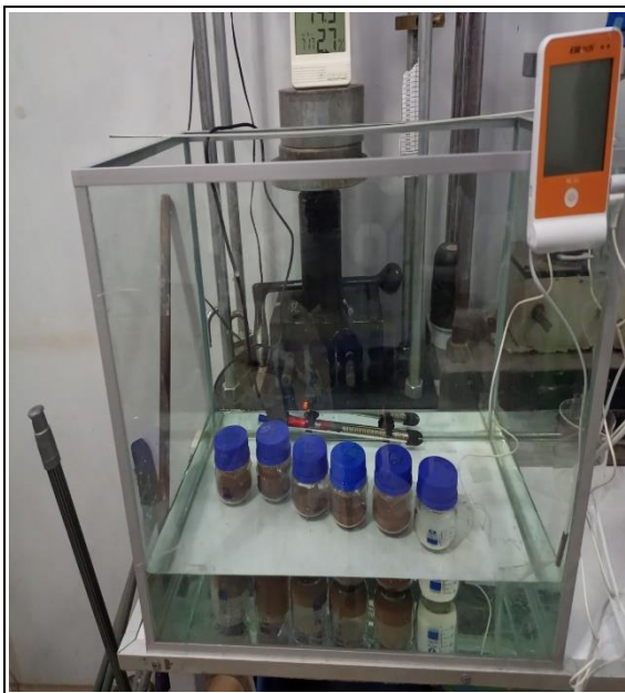
Figura 37 Mezclado de suelo, cal y agua con la prueba de Eades & Grim.
