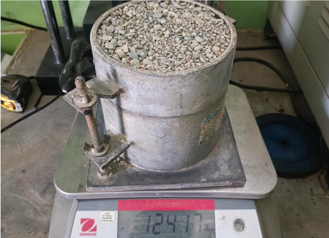
Peso unitario suelto y compactado del agregado reciclado
