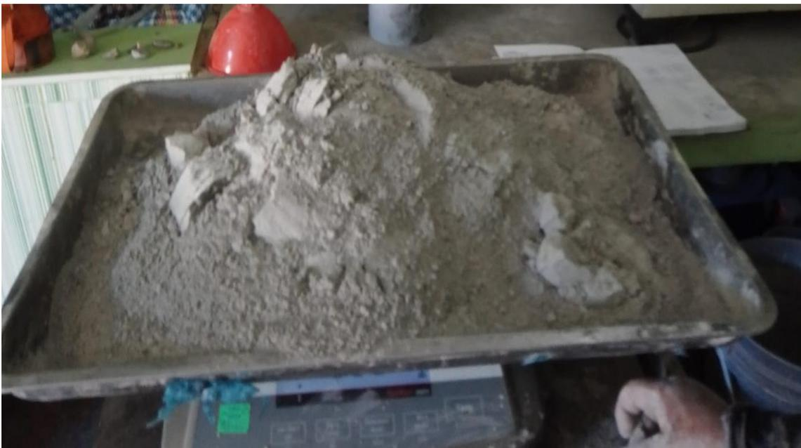
Pesado del cemento para la elaboración del adoquín
