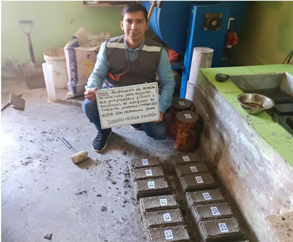
Desencofrado del adoquín con 25% de desecho de concreto
