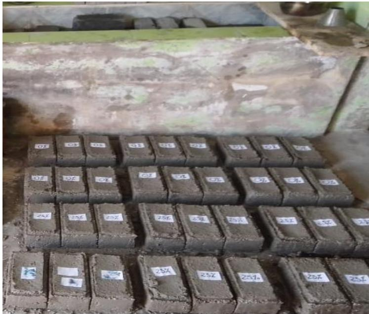
Adoquines con 0%,25%,45%,60% de desecho de concreto
