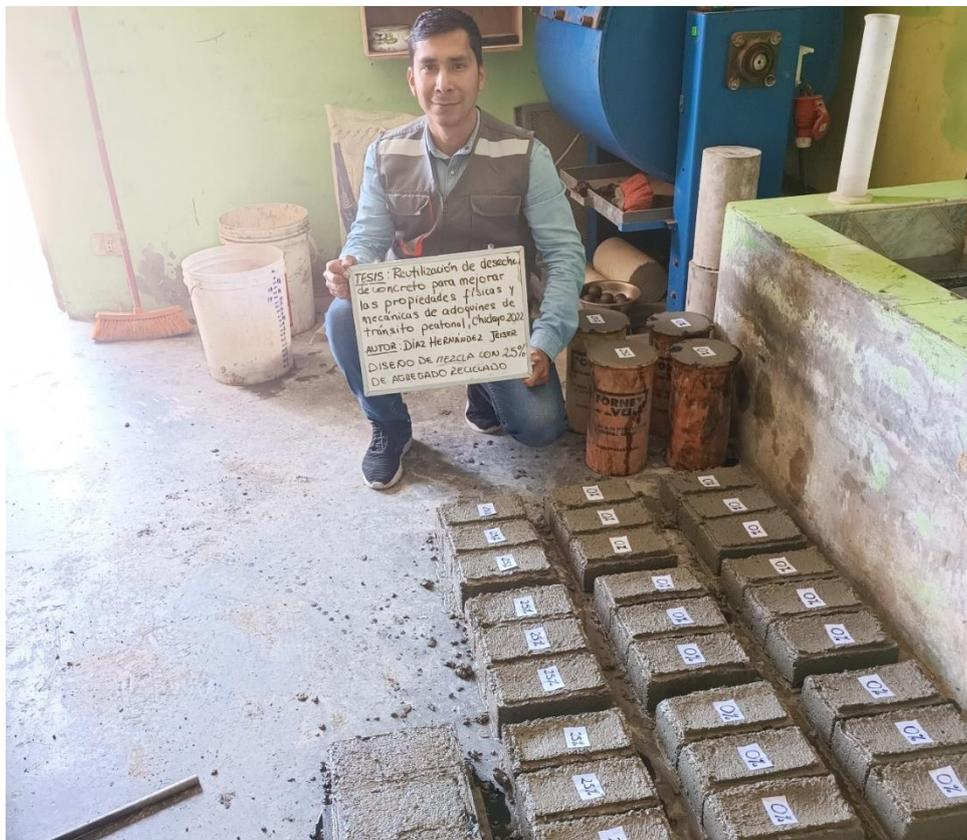
Desencofrado del adoquín sin desecho de concreto.
