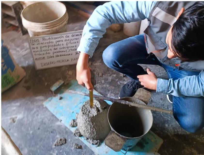
Ensayo de asentamiento (slump)
