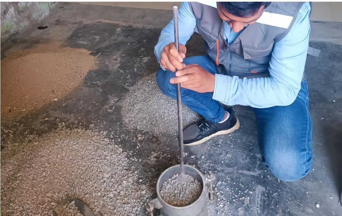
**Ensayo para el peso unitario suelto y compactado del agregado grueso**
