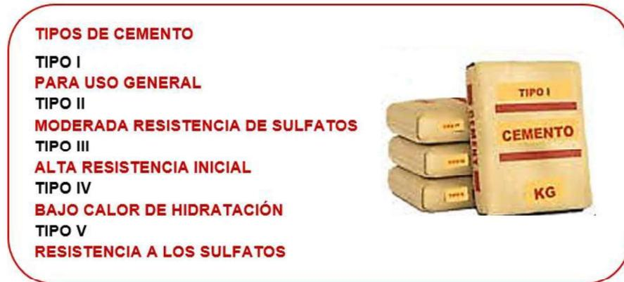
Figura 2. Tipos de cemento.
