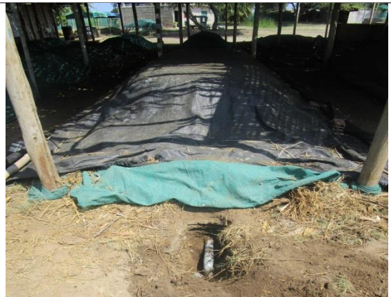
Figura 34: Limpieza de lixiviados Fuente: centro de compostaje.
