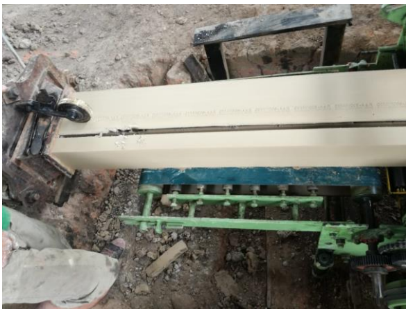
Figura 01. Falla en la extrusión Fuente: elaboración propia
